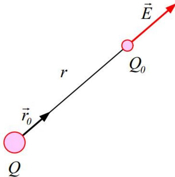
*Slika 2.3. Određivanje jakosti električnog polja točkastog naboja*
