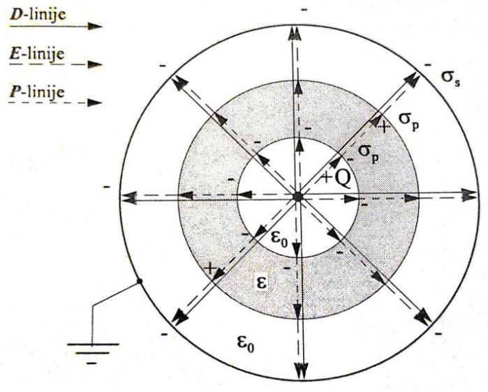
**Slika 2.13.** Gustoća tijeka pomaka  $\mathbf{D}$ , jakosti električnog polja  $\mathbf{E}$  i vektora polarizacije  $\mathbf{P}$  točkastog naboja  $Q$  smještenog u središte dielektrične ljuske  $\epsilon$  i uzemljenje metalne kugle [2].
