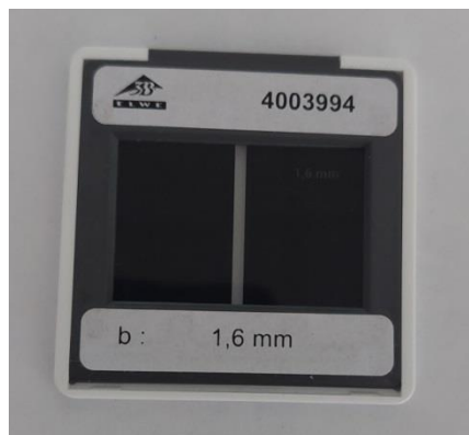
Slika 6.21. Prikaz korištene pukotine širine 1,6 mm
