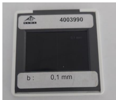
Slika 6.9. Prikaz korištene pukotine širine 0,1 mm
