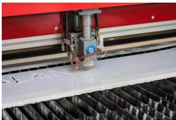
Slika 4.10. Prikaz primjera rada laserskog rezača pri rezanju pleksiglasa [8]
