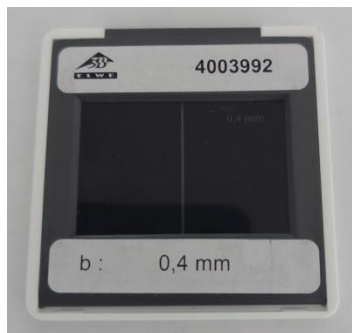
Slika 6.15. Prikaz korištene pukotine širine 0,4 mm
