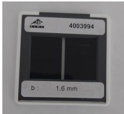
Slika 6.21. Prikaz korištene pukotine širine 1,6 mm
