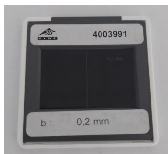
Slika 6.12. Prikaz korištene pukotine širine 0,2 mm
