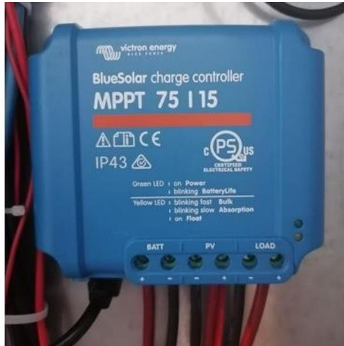
Slika 4.3. BlueSolar MPPT 75 |15 – regulator punjenja
