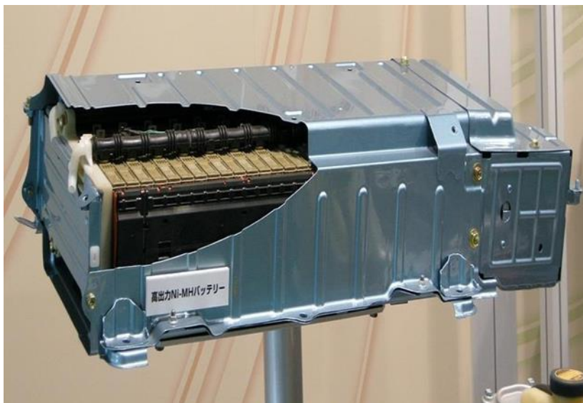
Slika 3.10. NiMH baterija za Toyota Prius [33]
