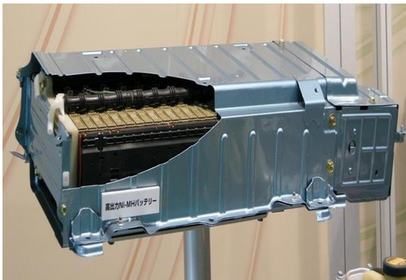
Slika 3.10. NiMH baterija za Toyota Prius [33]
