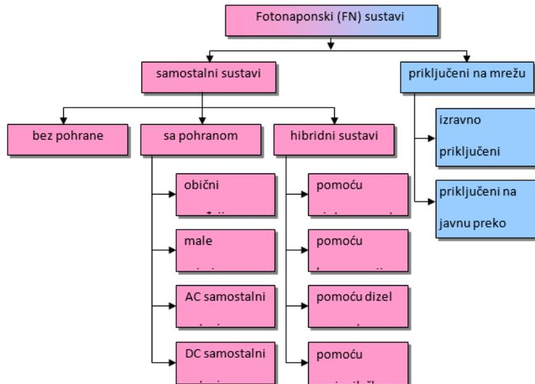
Slika 3.10, Prikaz osnovne podjele fotonaponskih sustava [22]
