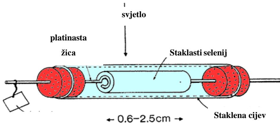
Slika 2.2, Prikazuje selenijsku fotonaponsku ćeliju [3]
