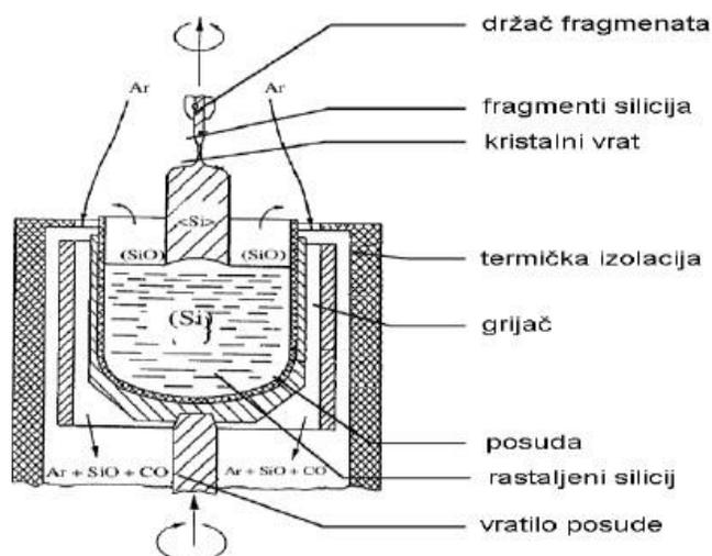
**Slika 3.2, Prikaz dobivanja monokristalnog silicija Czochralskijevom metodom [12]**
