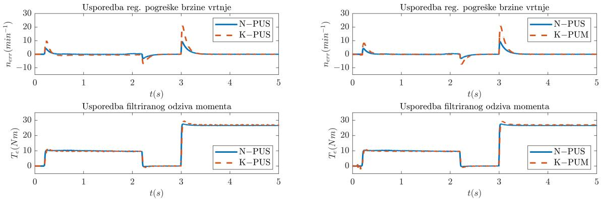
(a) Regulacijska pogreška brzine vrtnje i filtriranog odziva momenta predložene i konačne PUS metode.
