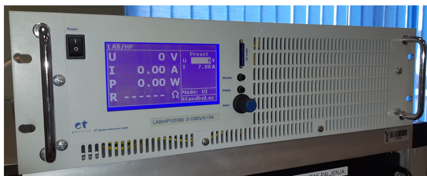
Slika 3.6: Laboratorijski izvor za napajanje energetskog pretvarača.
