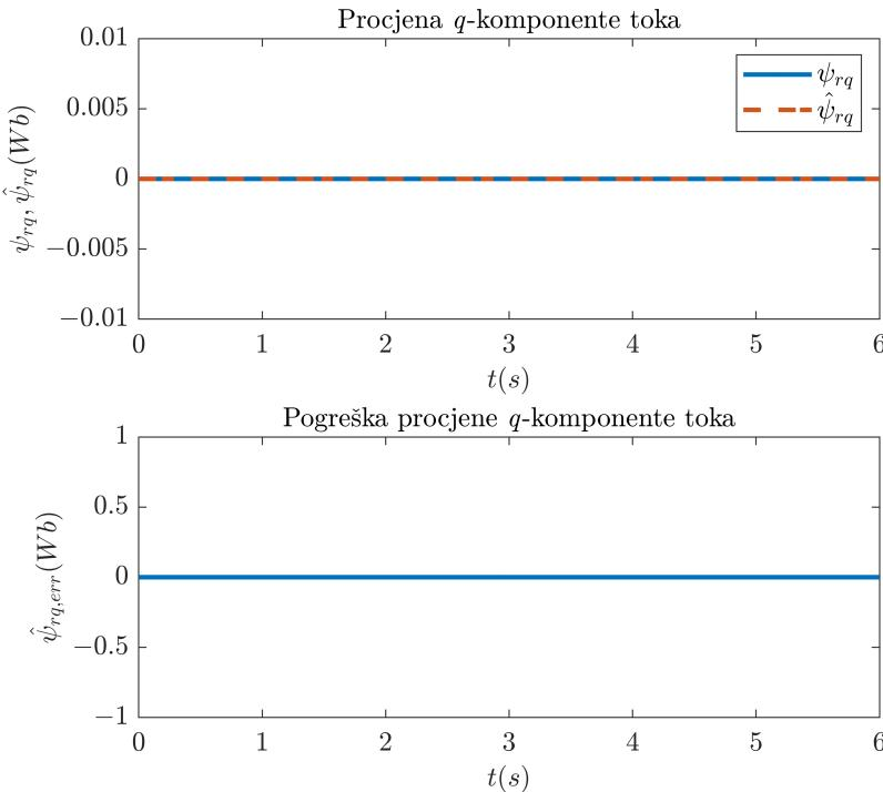
**Slika 4.19:** Performanse procjene  $q$ -komponente rotorskog toka
