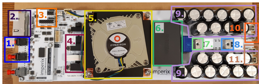
(a) Gornja strana energetskega modula.
