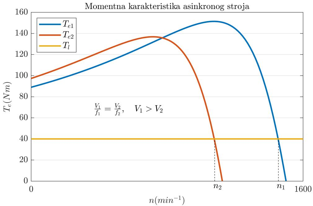
**Slika 3.20:** Momentna karakteristika asinkronog stroja.
