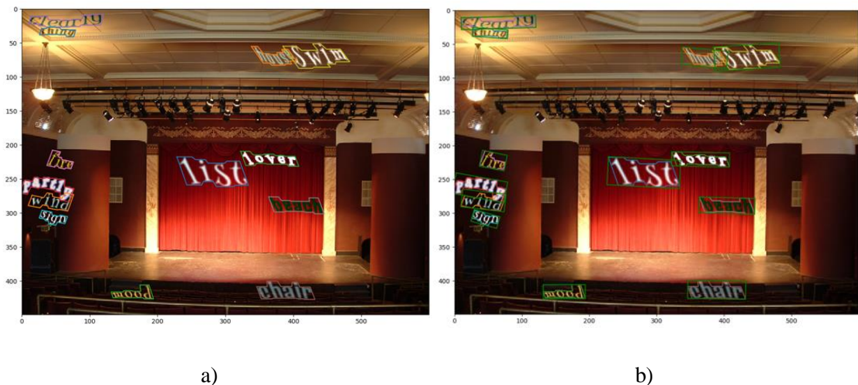
Slika 3.11. a) Vizualni prikaz oznaka slika kada se koristi granični okvir u obliku poligona, b) Vizualni prikaz oznaka slika kada se koristi granični okvir u obliku pravokutnika.
