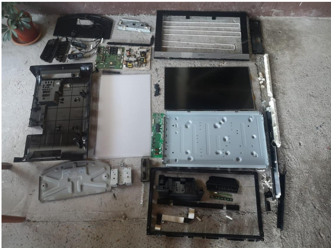
Sl. 3.3 LCD televizor SONY KDL-26EX302 poslije rastavljanja
