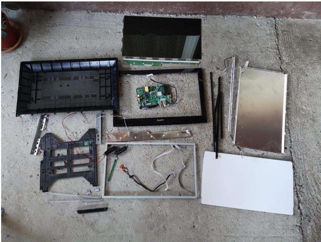
Sl. 3.5 LCD Quadro LCD-22AB1 poslije rastavljanja
