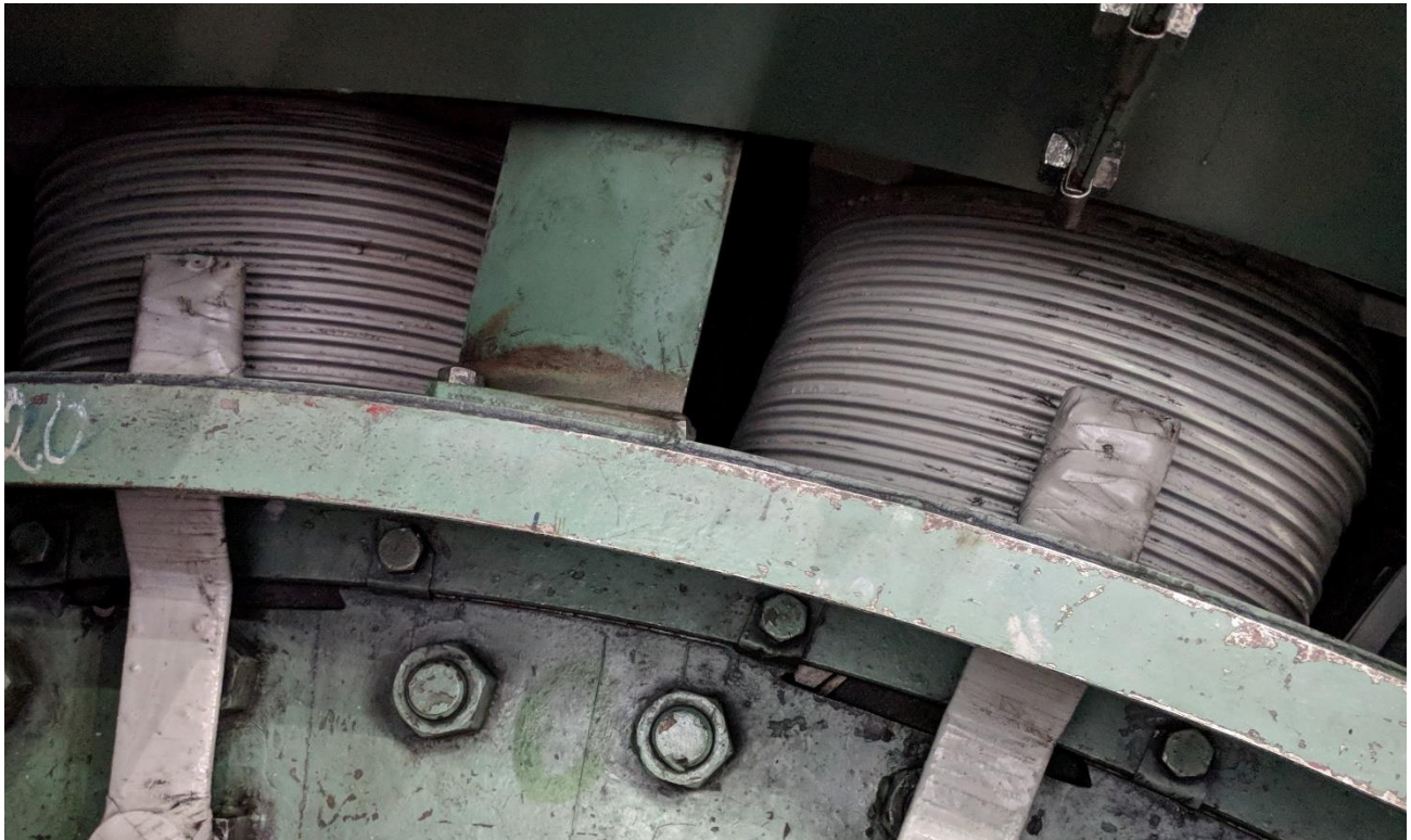
Slika 5.1. Prikaz zavoja u namotu rotora
