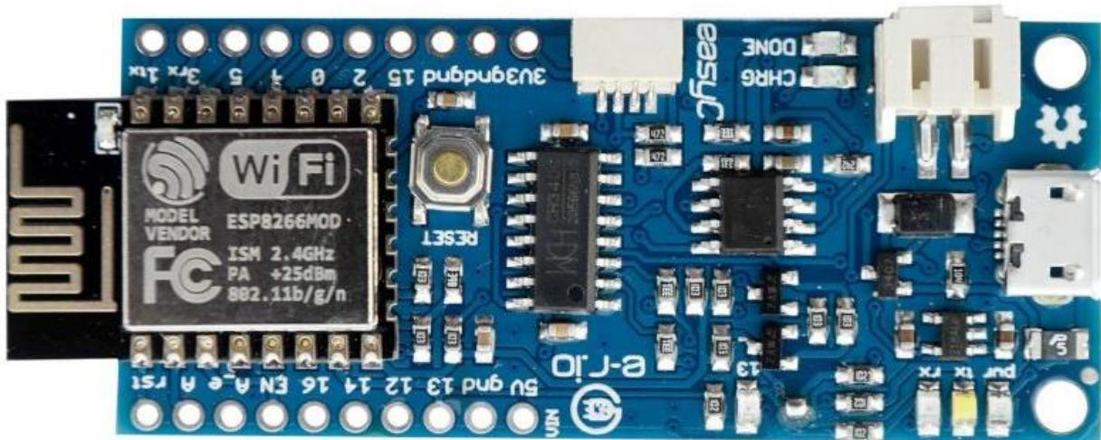
Slika 2.3. Croduino Nova 2 mikroupravljačka pločica<sup>3</sup>
