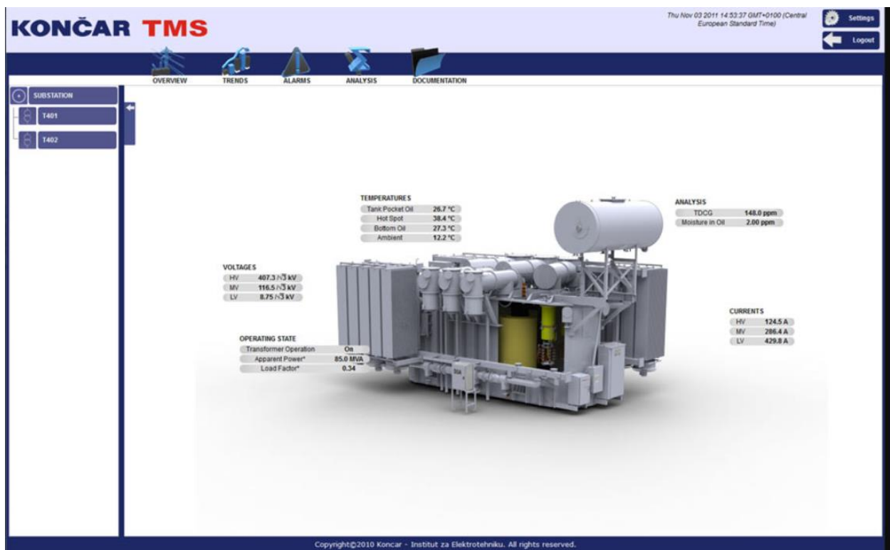
Slika 2.6. Končar TMS, sustav nadzora rada transformatora [19]
