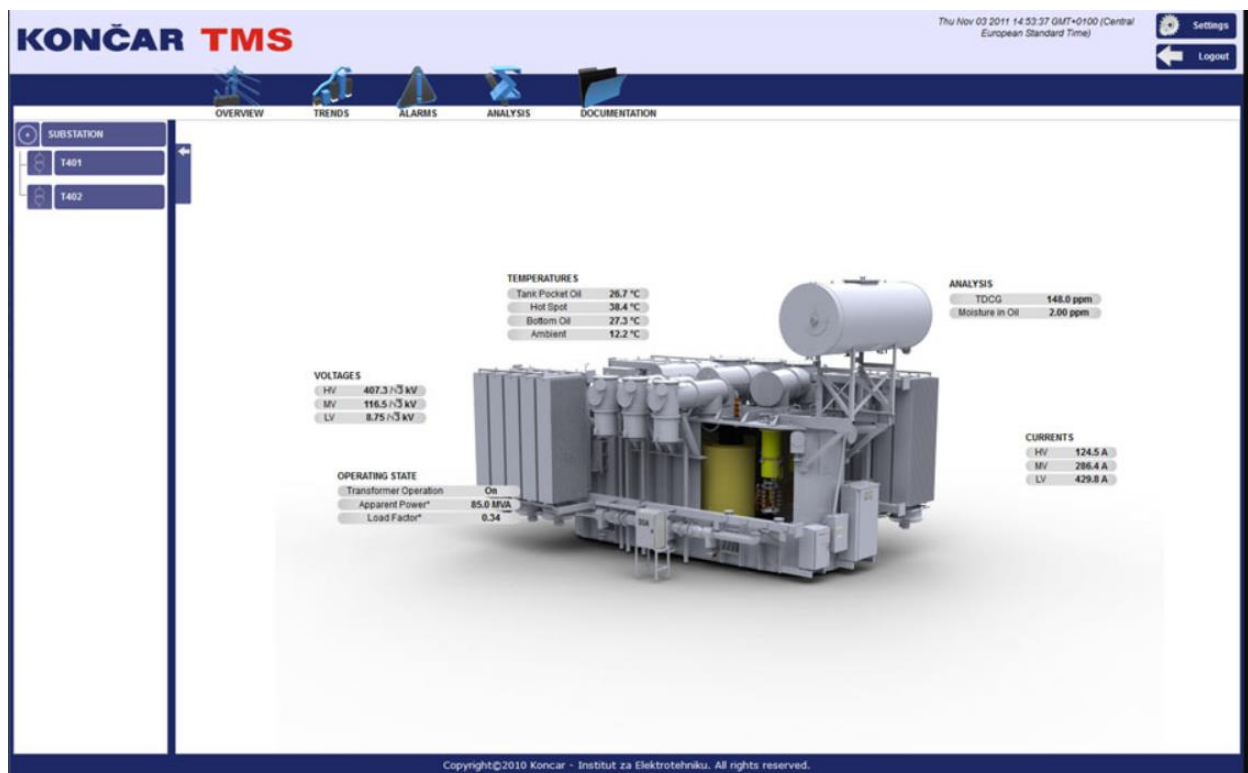
Slika 2.6. Končar TMS, sustav nadzora rada transformatora [19]
