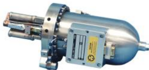
Slika 7.1. TRW mini cryocooler s pulsirajućom cijevi (Boyle i Ross, 2006, str. 3).
