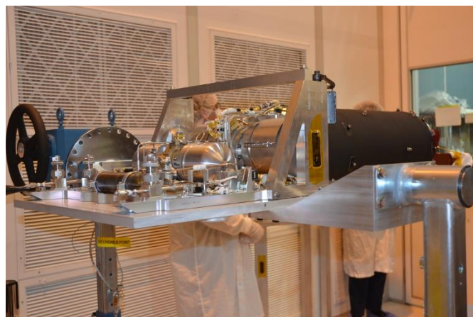
Slika 7.4. MIRI cryocooler iz JWST-a (MIRI).
