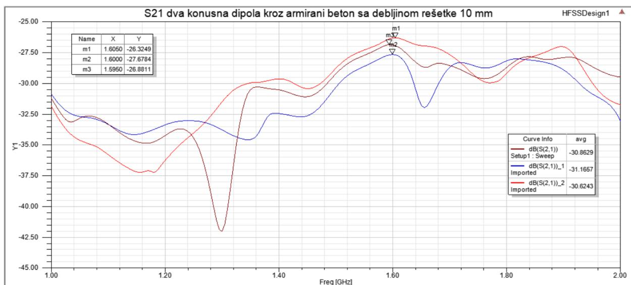
*Slika 5.76. Koeficijent transmisije  $S_{21}$  kroz prepreku od armiranog betona sa dimenzijama rešetke  $70x70$  (crvena krivulja),  $100x100$  (plava krivulja) i  $140x140$  (smeđa krivulja), i debljinom rešetke od  $10\text{ mm}$  u frekvencijskom opsegu  $1\text{-}2\text{ GHz}$*
