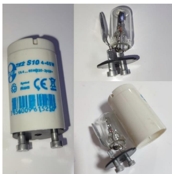
Slika 3.5. Starter sa i bez kućišta
