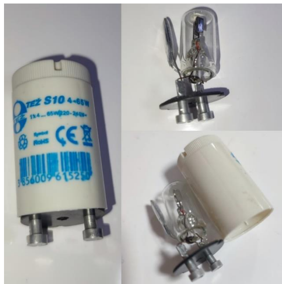
Slika 3.5. Starter sa i bez kućišta
