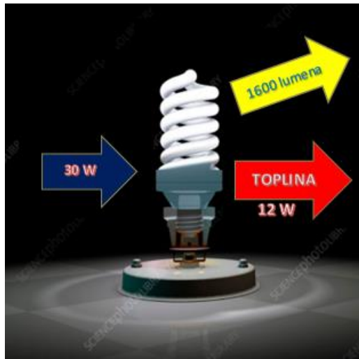
Slika 3.13. Energetska učinkovitost CFL žarulje snage 30 W [26]
