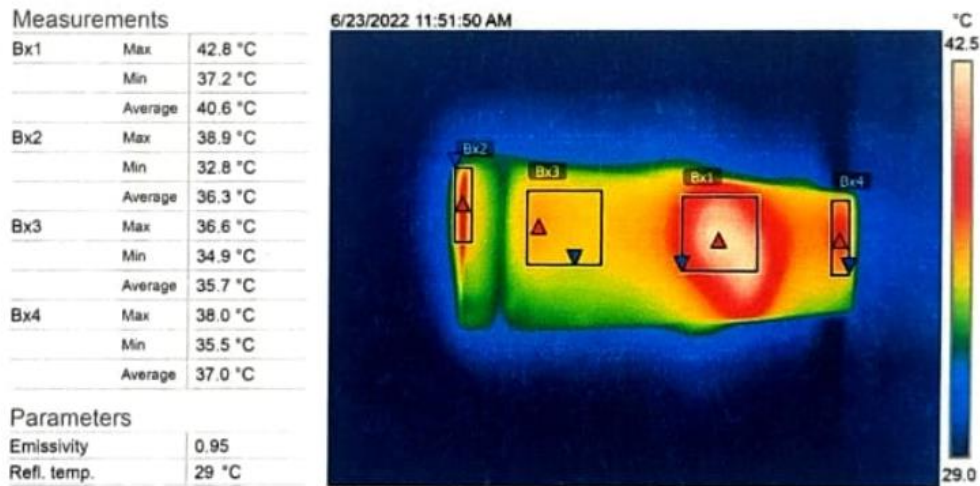
Slika 5.1. Termalni obrazac neposredno nakon otkaza prigušnice [48]
