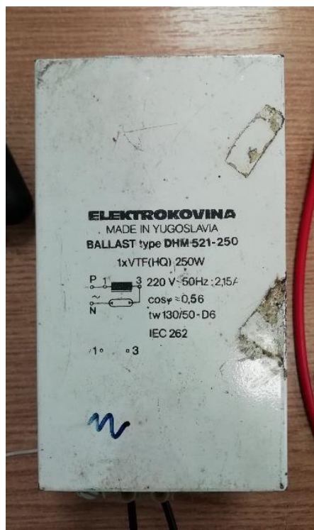
Sl. 3.4. Zavojnica korištena u pokusima
