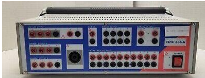
Slika 4.2. Uređaj za testiranje i kalibraciju Omicron CMC 256-6
