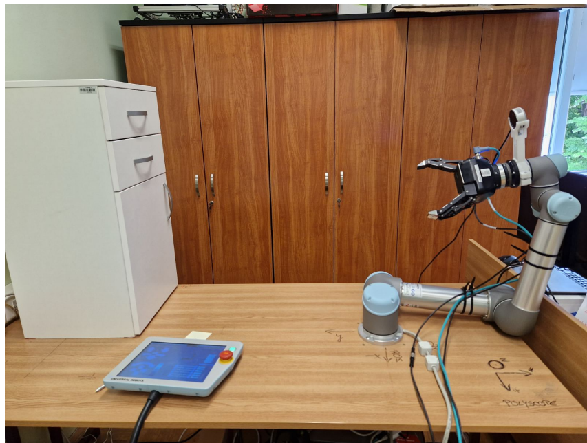
Slika 6.16: Primjer lošeg položaja robotskog manipulatora u trenutku snimanja scene
