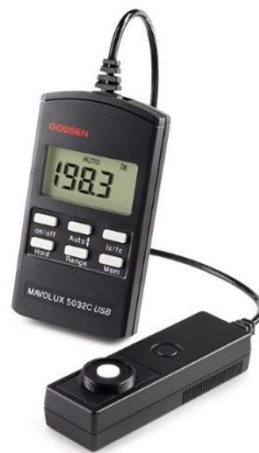
Sl. 3.9. Luxmetar Gossen Mavalux 5032C USB [17]
