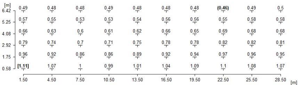
Sl. 4.9. Vrijednosti sjajnosti kolnika u \text{cd/m}^2
