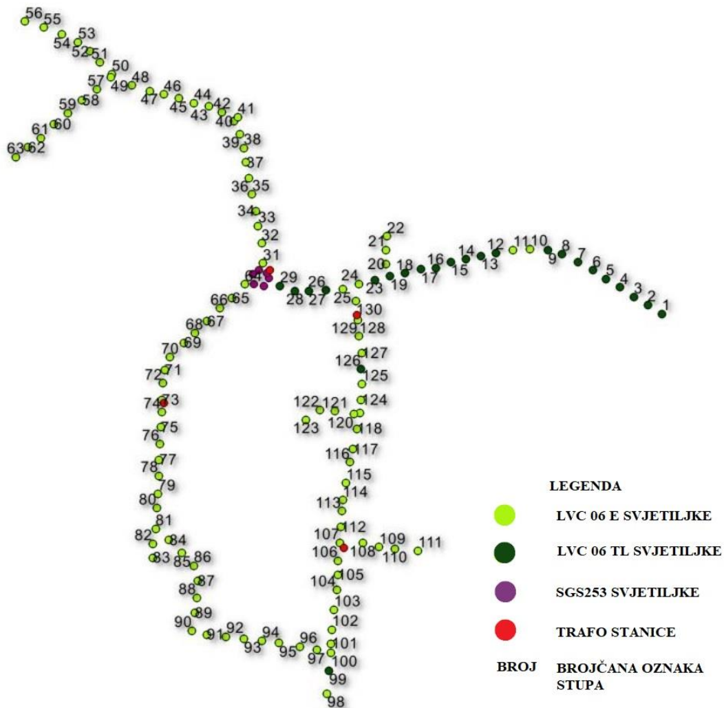
Sl. 3.1. Mapirani elementi sustava javne rasvjete [24]
