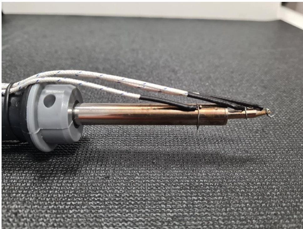
Slika 6.4. položaj temperaturnih sondi na leмноj stanici Conrad Electronic LSL-450
