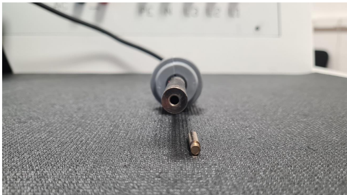
Slika 6.12. Prikaz punog vrha lemne stanice Conrad Electronic LSL-450
