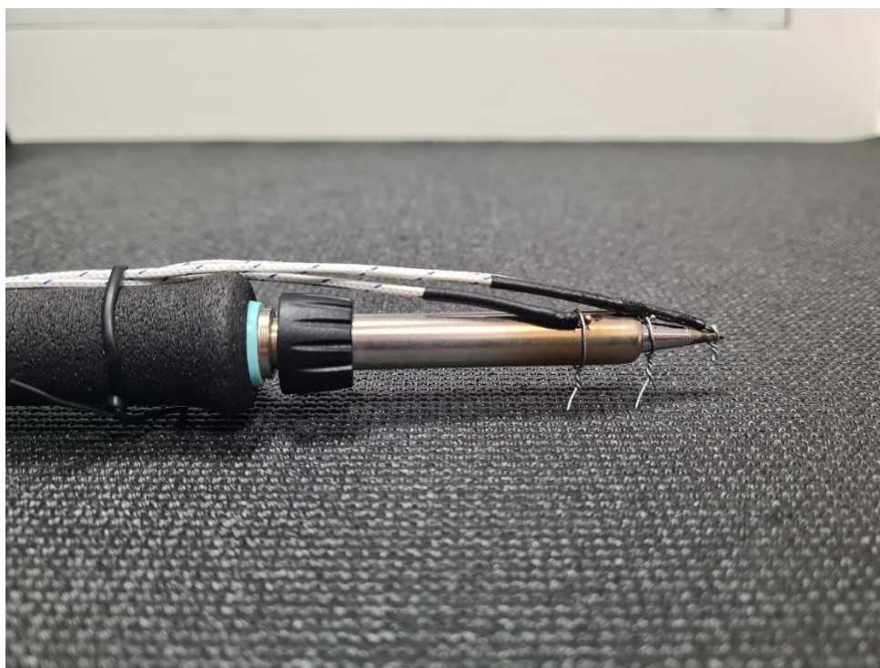
Slika 6.3. položaj temperaturnih sondi na lemnoj stanici Weller WE-1010
