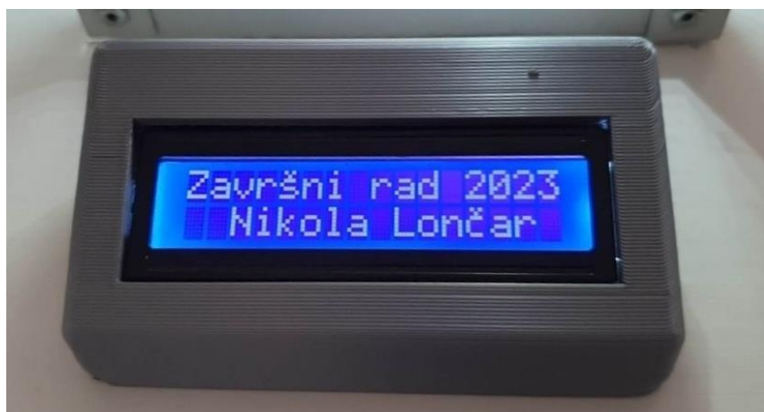
Sl. 3.14. Prikaz teksta ispisanog na 16x2 zaslonu
