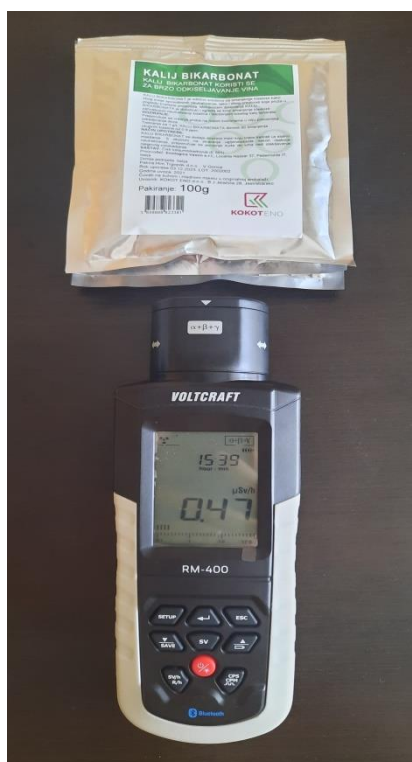
Slika 5.8. Izmjerena vrijednost zračenja kalijevo bikarbonata
