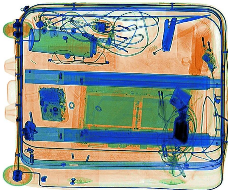
Slika 4.4. Prtljaga skenirana rendgenskim uređajem
