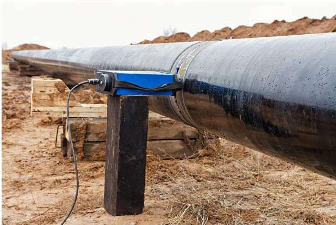
**Slika 4.3.** Radiografija zavara na plinovodu
