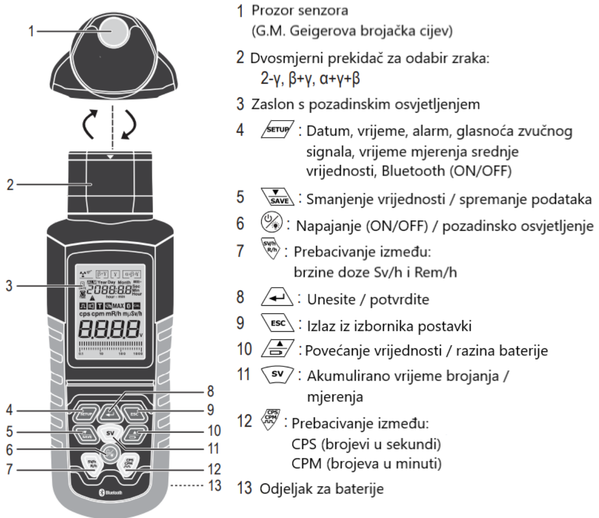
Slika 5.4. Dijelovi Geigerovog mjerača zračenja
