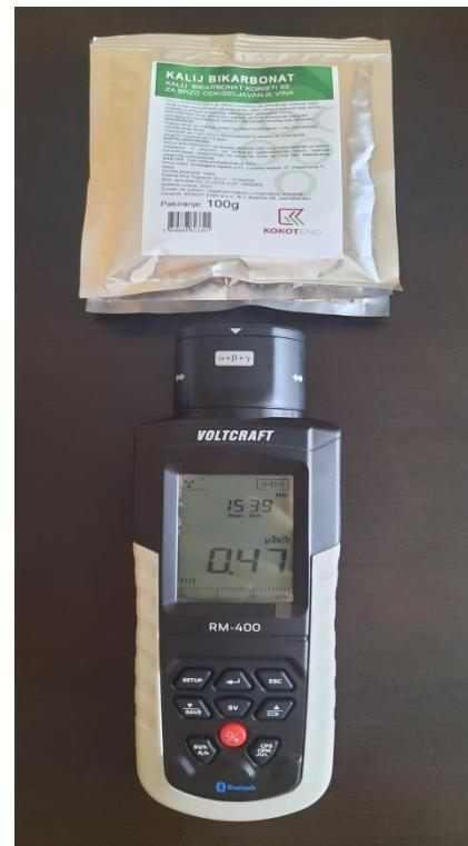
**Slika 5.8.** Izmjerena vrijednost zračenja kalijevog bikarbonata
