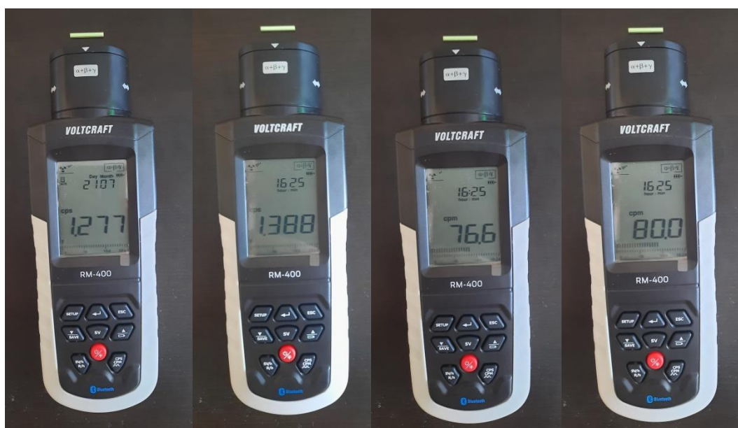
Slika 5.16. Izmjerene vrijednosti cps (prva i druga slika s lijeve strane) i cpm (prva i druga slika s desne strane) za beta light emiter
