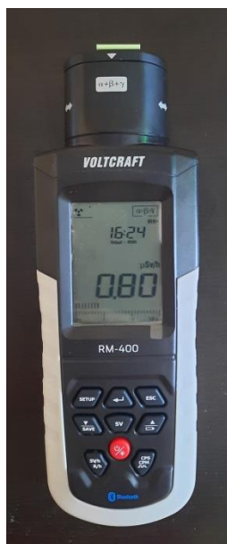
Slika 5.15. Izmjerena vrijednost zračenja beta light emitera
