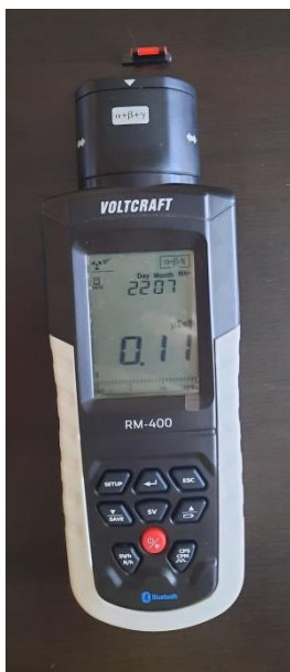
Slika 5.17. Izmjerena vrijednost zračenja mušice nišana oružja
