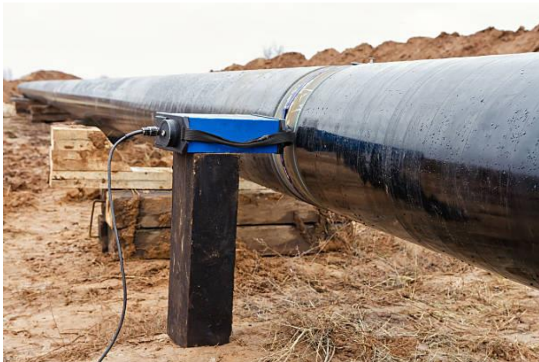
Slika 4.3. Radiografija zavara na plinovodu
