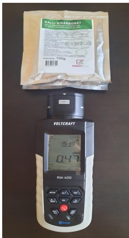
Slika 5.8. Izmjerena vrijednost zračenja kalijevo bikarbonata
