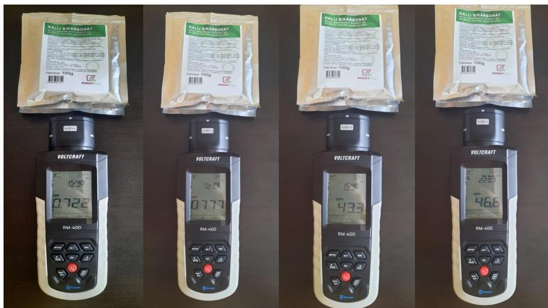
**Slika 5.10.** Izmjerene vrijednosti cps (prva i druga slika s lijeve strane) i cpm (prva i druga slika s desne strane) za kalijev bikarbonat
