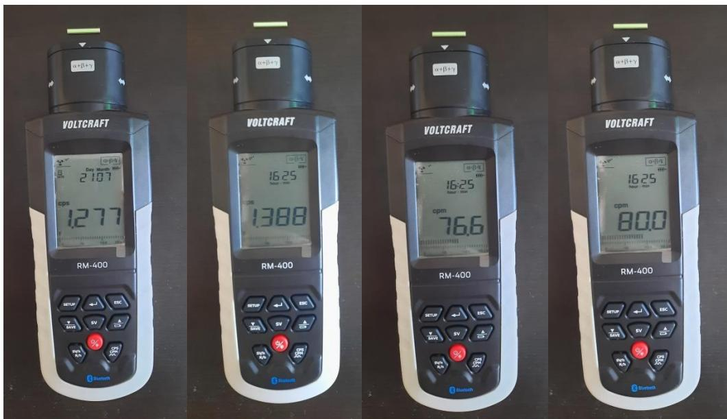
**Slika 5.16.** Izmjerene vrijednosti cps (prva i druga slike s lijeve strane) i cpm (prva i druga slika s desne strane) za beta light emiter
