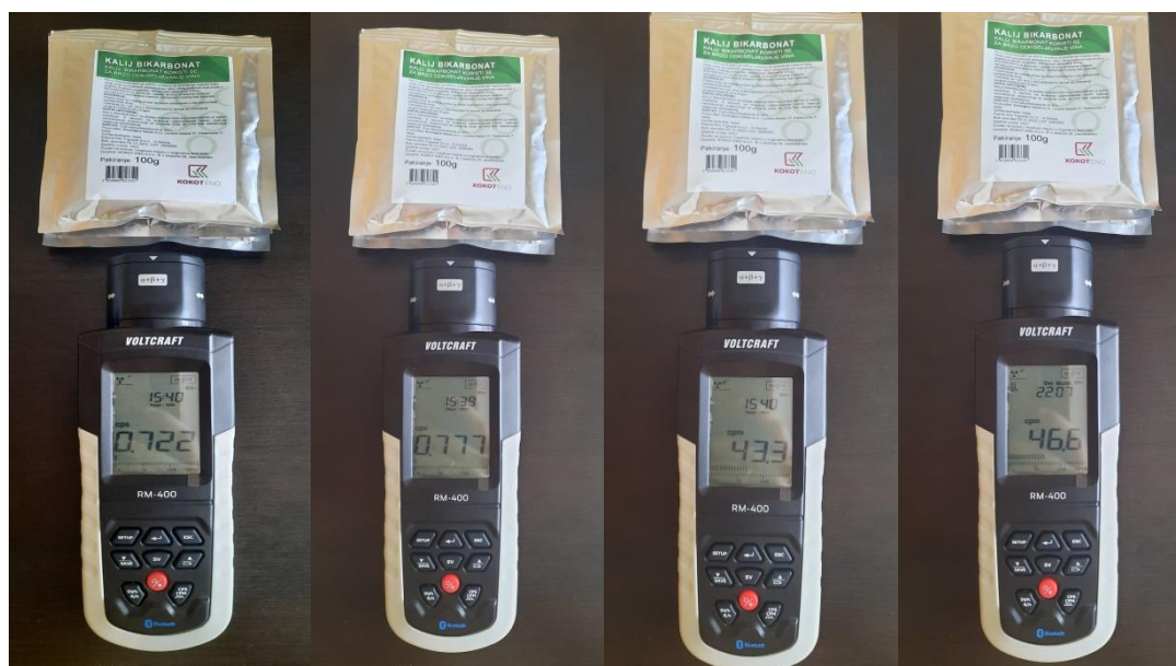
Slika 5.10. Izmjerene vrijednosti cps (prva i druga slika s lijeve strane) i cpm (prva i druga slika s desne strane) za kalijev bikarbonat
