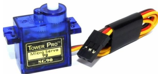
Slika 3.6. TowerPro SG90 servo motor
