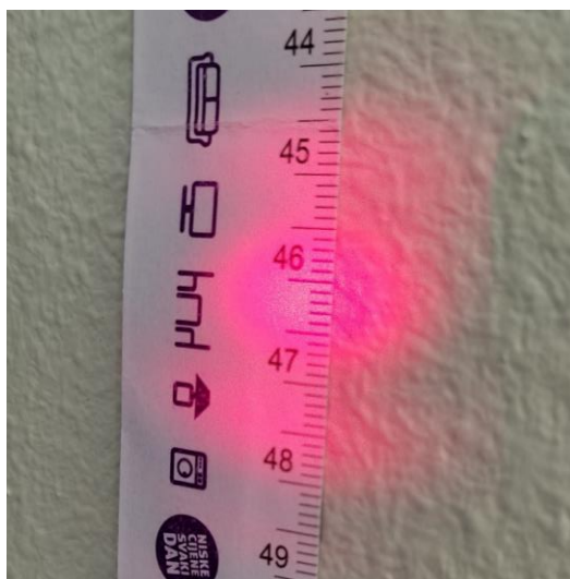
Sl. 4.19. Nepravilan oblik osvijetljene točke na udaljenosti 57,55 m, uočava se rasipanje svjetlosti.
