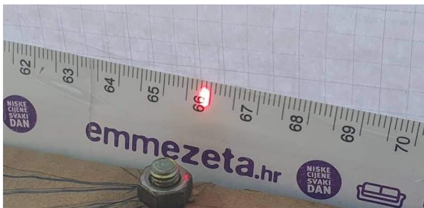
Sl. 4.10 Osvijetljena točka prilikom mjerenja pod kutom od 90^\circ u odnosu na predmet mjerenja
