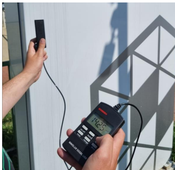
Sl. 4.16. Postupak mjerenja luminancije, svjetlomjer pokazuje vrijednost luminancije od 14250 cm/m 2 .
