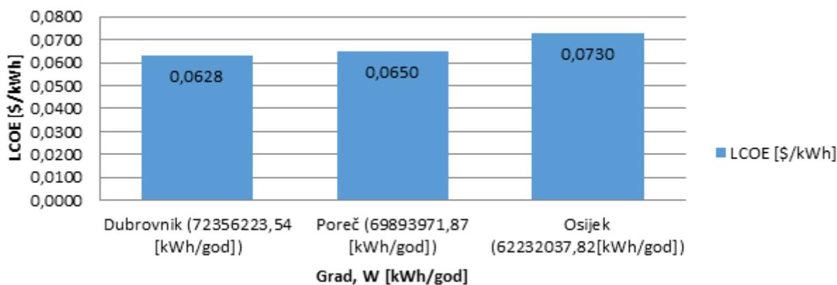
**Slika 3.4.** Grafički prikaz ovisnosti LCOE o očekivanoj godišnjoj proizvodnji električne energije na odabranim lokacijama
