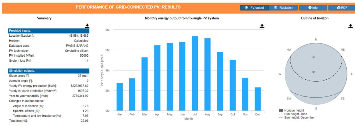
**Slika 3.3.** Proračun očekivane godišnje proizvodnje električne energije za lokaciju Osijek [10]
