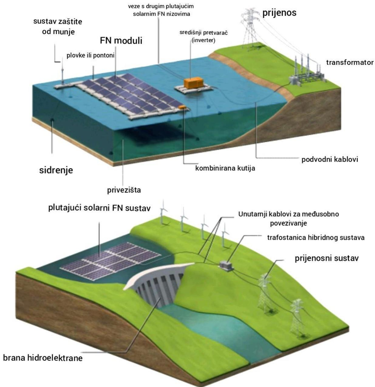
**Slika 2.2.** Reprezentativne konfiguracije samostalnog PFN sustava (gore) i hibridnog PFN-hidroenergetskog sustava (dolje) [4]
