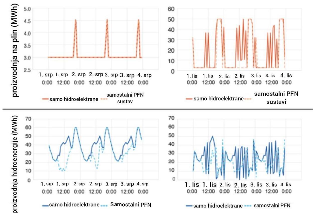
**Slika 2.9.** Proizvodnja na plin (gore) i proizvodnja hidroenergije (dolje) za samo hidroelektrane i samostalne PFN sustave, kišna sezona (1. – 3. srpnja; lijevo) i sušna (1. – 3. listopada; desno).
