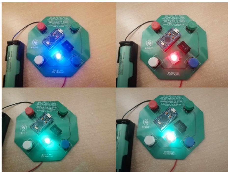
Sl. 4.1. Sklop svijetli u svakoj od 4 moguće boje: a) plavo b) crveno c) zeleno i d) bijelo.
