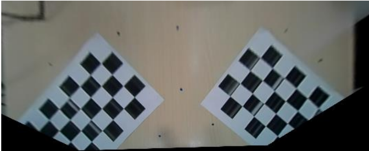
Slika 3.17. Prikaz s prednje kamere nakon transformacije perspektive u pogled odozgo
