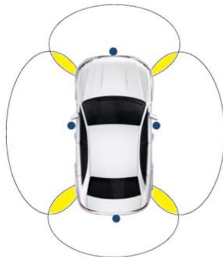
Slika 2.1. Područje prikaza kamera fiksiranih na vozilu [21]
