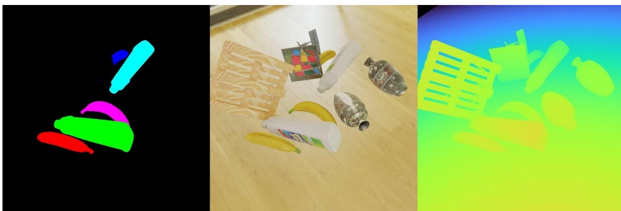
Slika 4.4. Slika koju iscrtava bpycv segmentacija po instancama ,RGB slika i dubinska slika [10].
