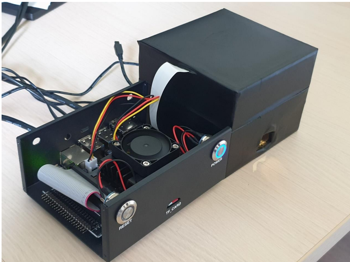
Slika 3.3. Prikaz fizičkog okruženja za očitavanje otiska prsta s pripadnim sklopovljem
