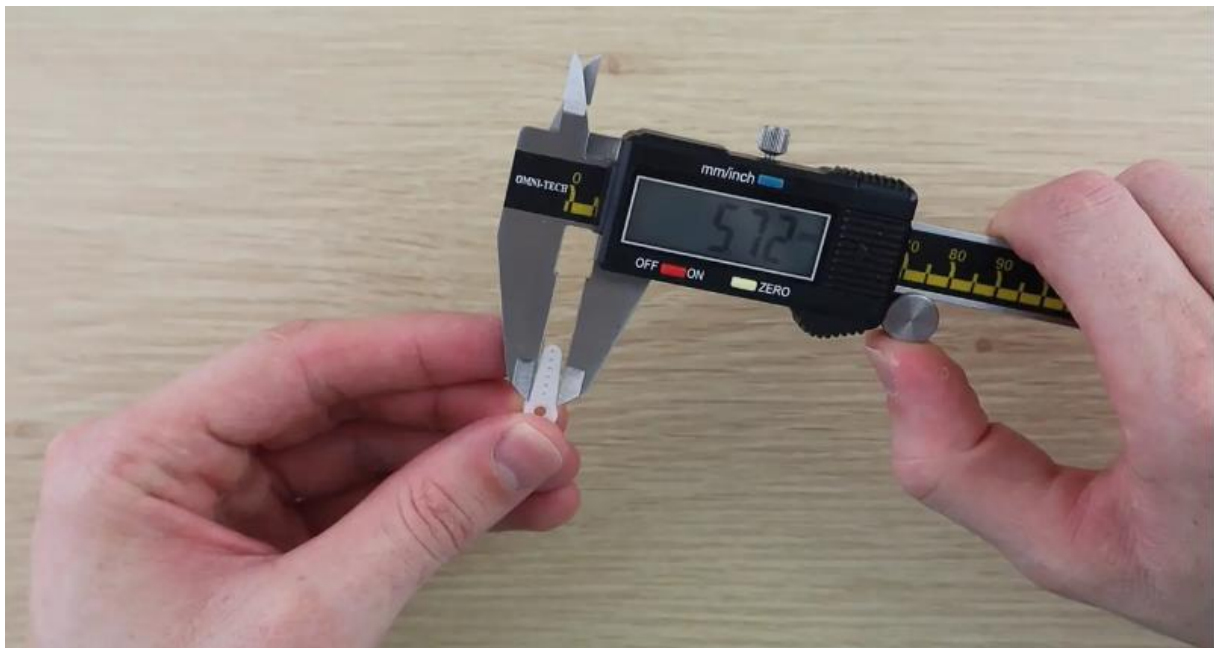
Slika 3.1. Mjerenje ruke servo motora.
