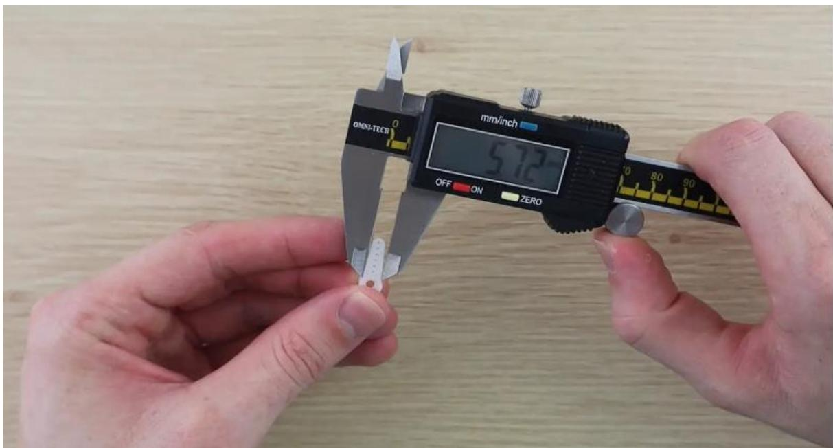
Slika 3.1. Mjerenje ruke servo motora.
