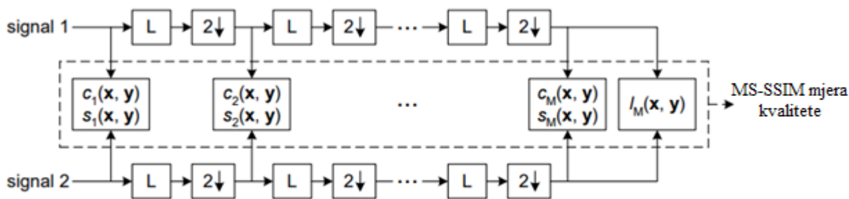
Slika 2.6. Sustav mjerenja kvalitete videa MS-SSIM algoritmom, gdje je L: nisko propusno filtriranje, a ↓: smanjivanje rezolucije [10]
