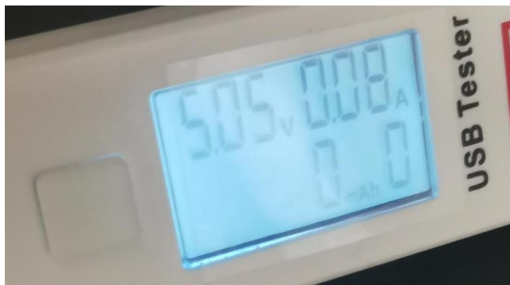
Sl. 5.2. Vrijednost struje nakon odaslane UDP poruke
