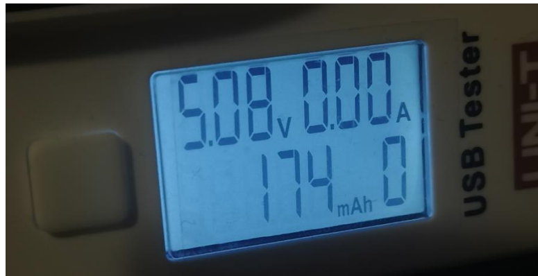
Sl. 5.6 – Vrijednost struje unutar PSM-a
