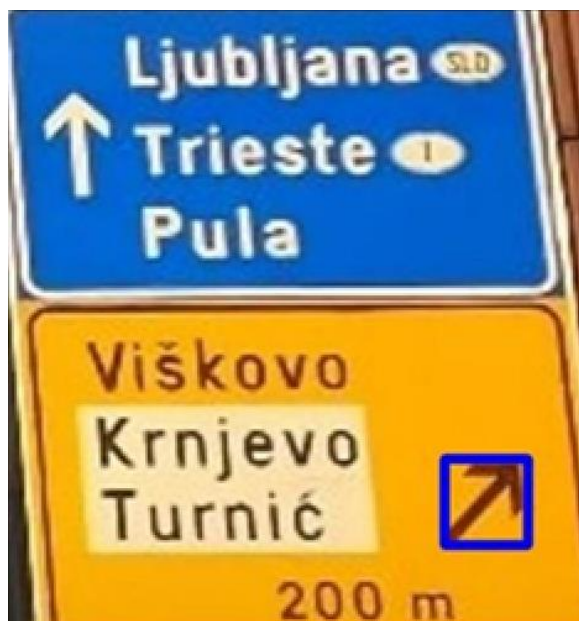
Slika 3.12. Neuspjeh detekcije svih smjerova na izrezanom putokazu zbog ograničene otpornosti predloška (označen plavim graničnim okvirom) na rotaciju
