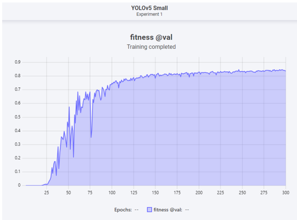
Slika 3.19. Graf fitness-epoha nakon treniranja YOLOv5 small modela na web usluzi Theos AI [42]
