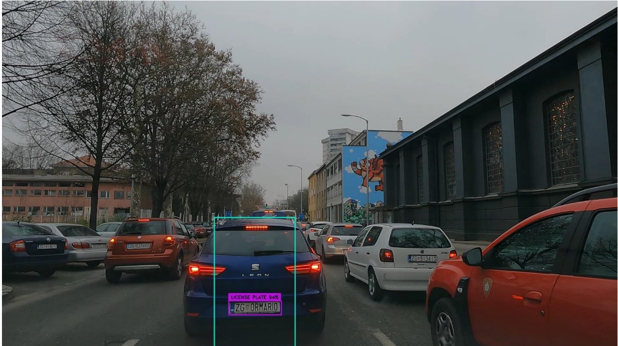
Slika 3.25. Filtriranje detekcija graničnog okvira registarske tablice vozila na one koje se nalaze unutar područja ispred vozača – 1. primjer
