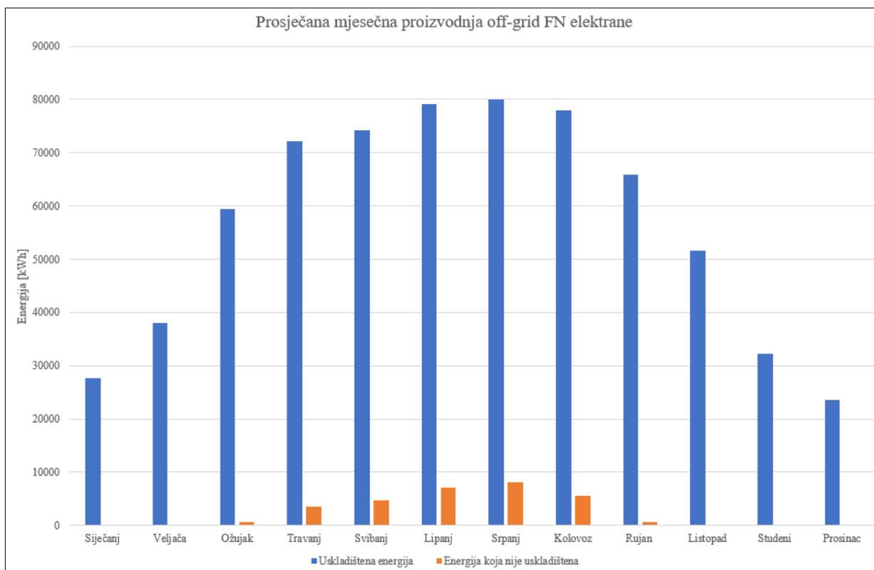
Slika 6.10. Prosječna mjesečna proizvodnja 20 kW *off-grid* FN elektrane
