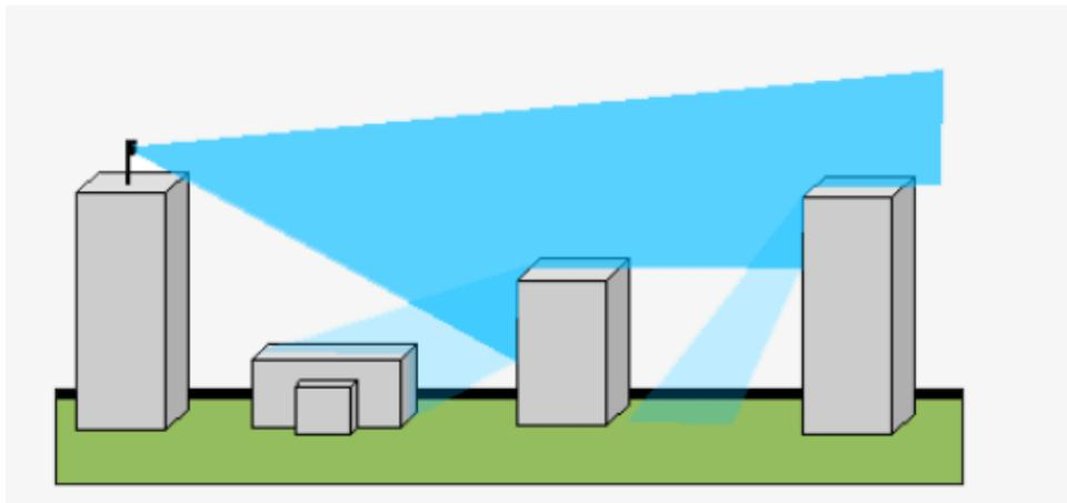
Slika 3.11. Prikaz smetnji koje nastaju zbog visokih zgrada [14]
