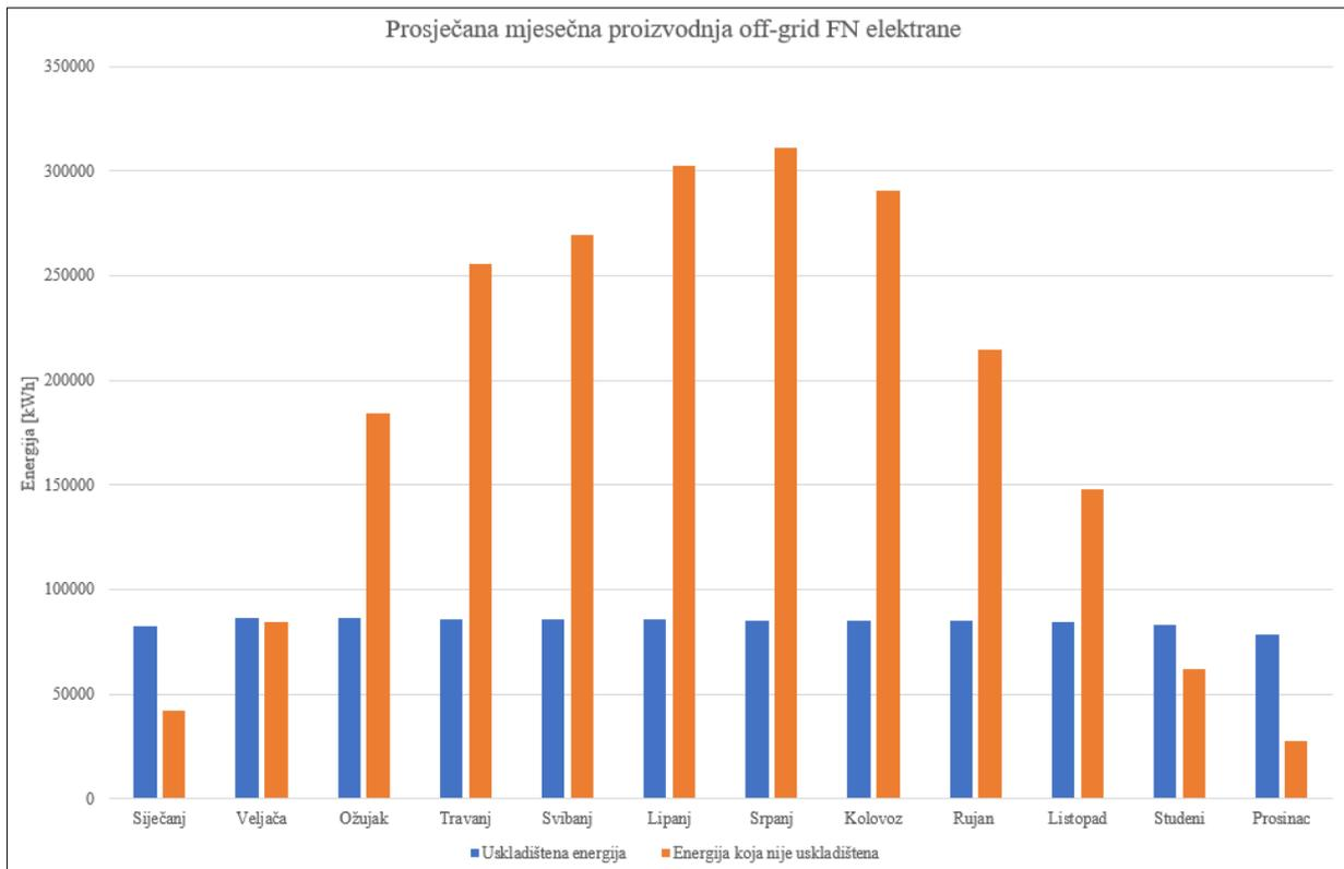
Slika 6.7. Prosječna mjesečna proizvodnja 90 kW *off-grid* FN elektrane
