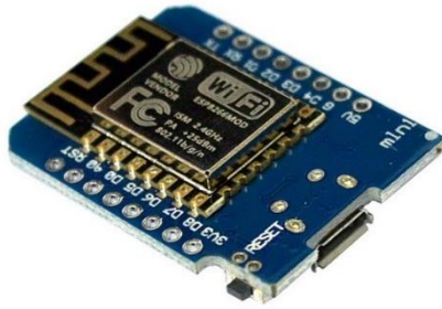
Sl. 3.4. ESP8266 mikroupravljačka pločica (WeMos D1 mini). [10]
