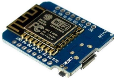
Sl. 3.4. ESP8266 mikroupravljačka pločica (WeMos D1 mini). [10]
