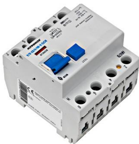
Slika 7.8. FID sklopka 80-4-03/A. S izvedba, za frekventne pretvarače (tip U), Serija BC, Tip A (osjetljiva na pulsne struje), Norma EN 61008
