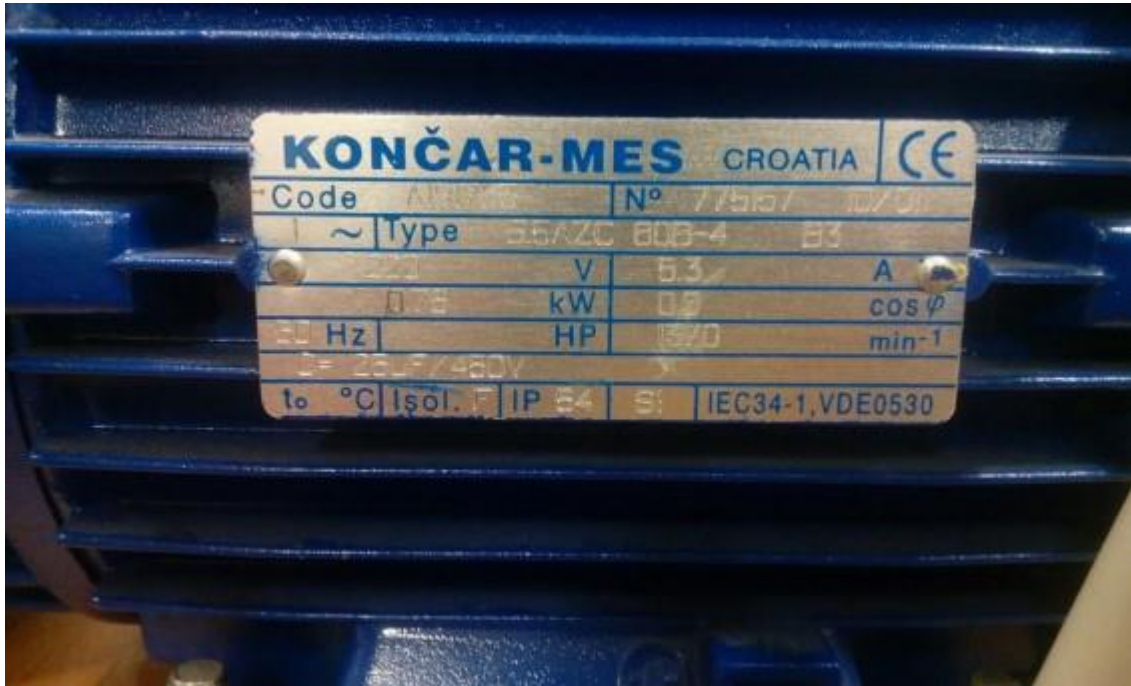
Slika 2.4. Nazivna pločica jednofaznog asinkronog motora marke Končar
