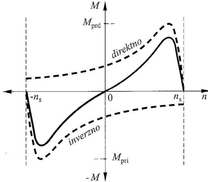
Slika 2.3. Karakteristika momenta jednofaznog asinkronog motora [1]
