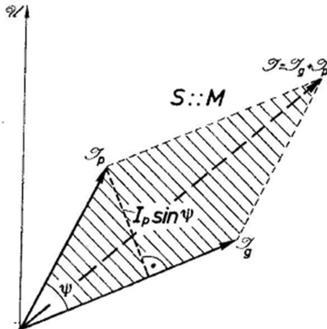
Slika 2.9. Dijagram struja jednofaznog motora s pomoćnom fazom za zalet i veličina poteznog momenta [2]
