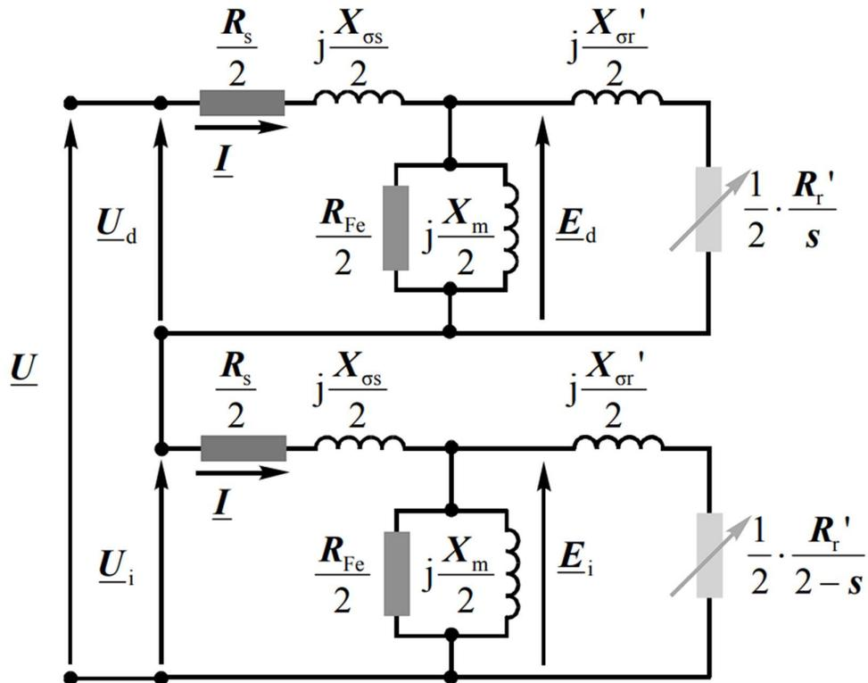
Slika 2.4. Nadomjesna shema jednofaznog asinkronog motora [4]
