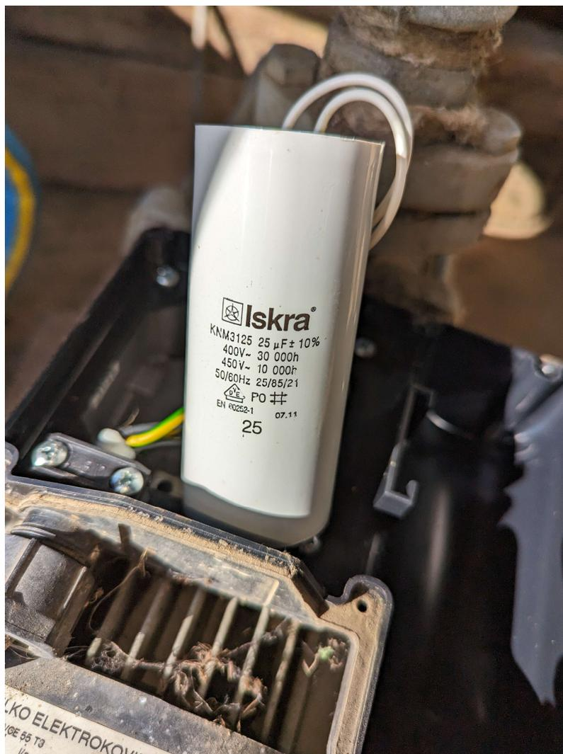
Slika 5.4. Radni kondenzator pogonskog motora
