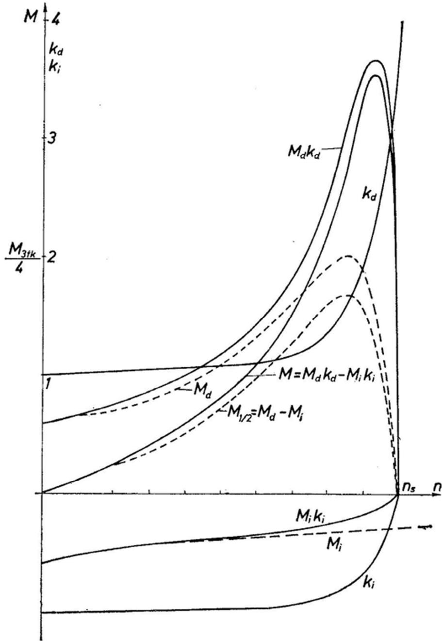
Slika 2.5. Korigirana momentna karakteristika jednofaznog asinkronog motora [2]
