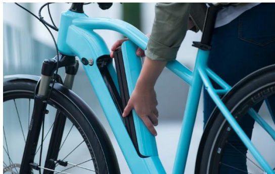
Slika 2.6. Baterijski paket integriran u okvir bicikla [9]
