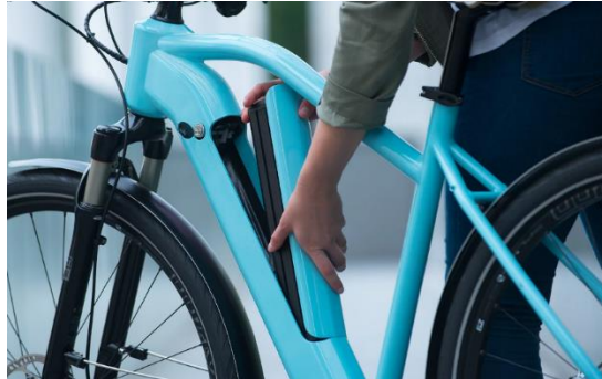
Slika 2.6. Baterijski paket integriran u okvir bicikla [9]
