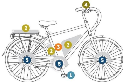
Slika 2.4. Smještaj motora i baterije [5]
