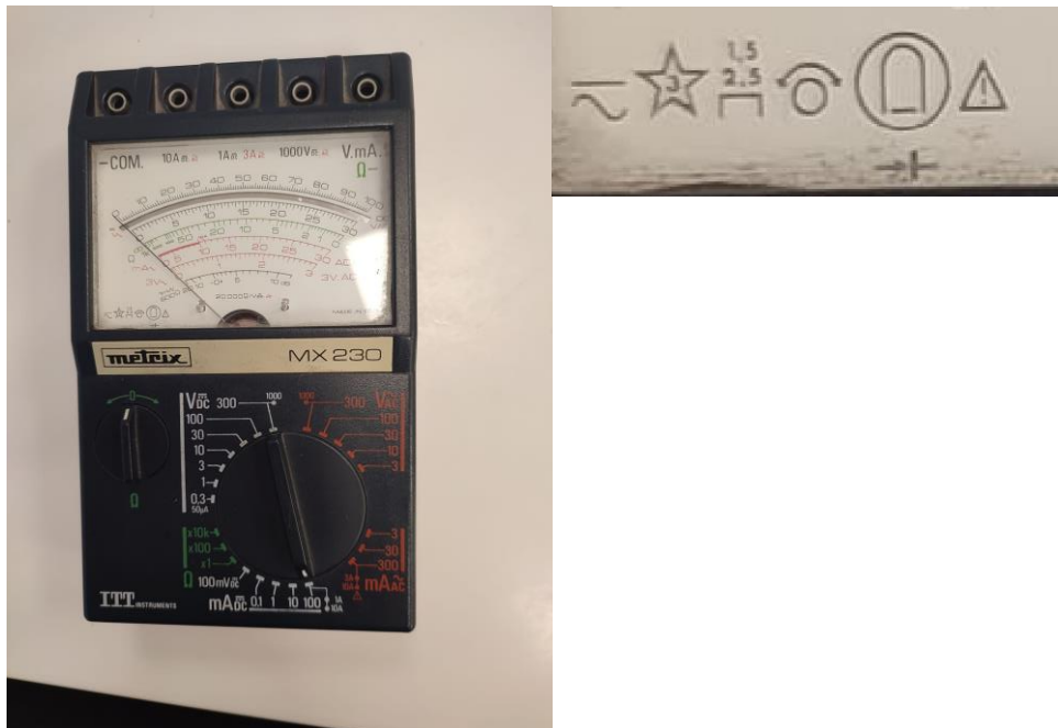
Slika 5.11. MX 230 – instrument s pomičnim svitkom sa ugrađenim ispravljačem i njegove značajke.
