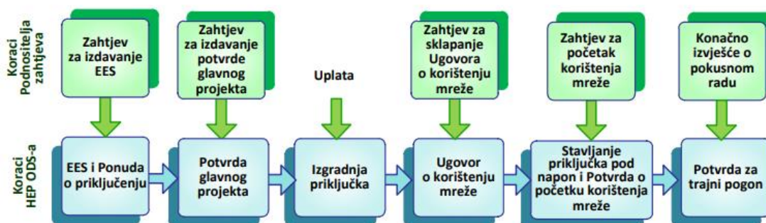
Slika 4.4. Jednostavno priključenje na mrežu uz uvjetovan probni rad [9]
