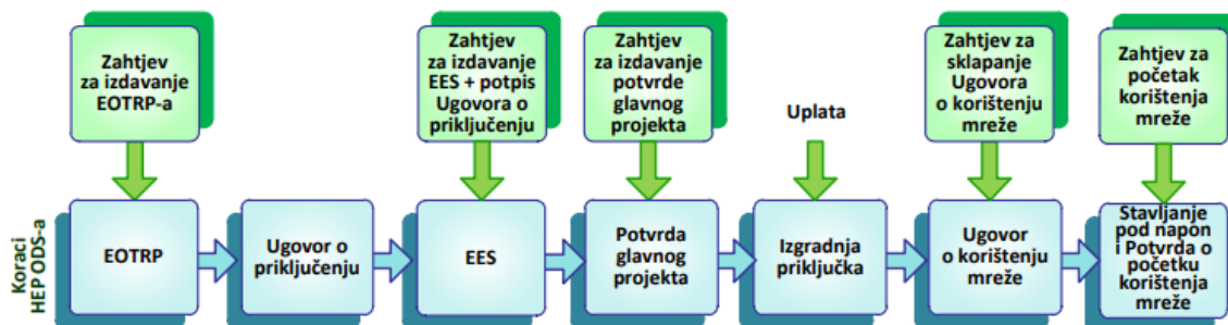
Slika 4.4. Složeno priključenje na mrežu [8]
