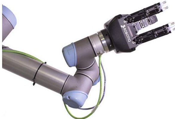
Slika 5.3 Universal Robots Robotiq 3-Finger hvataljka
