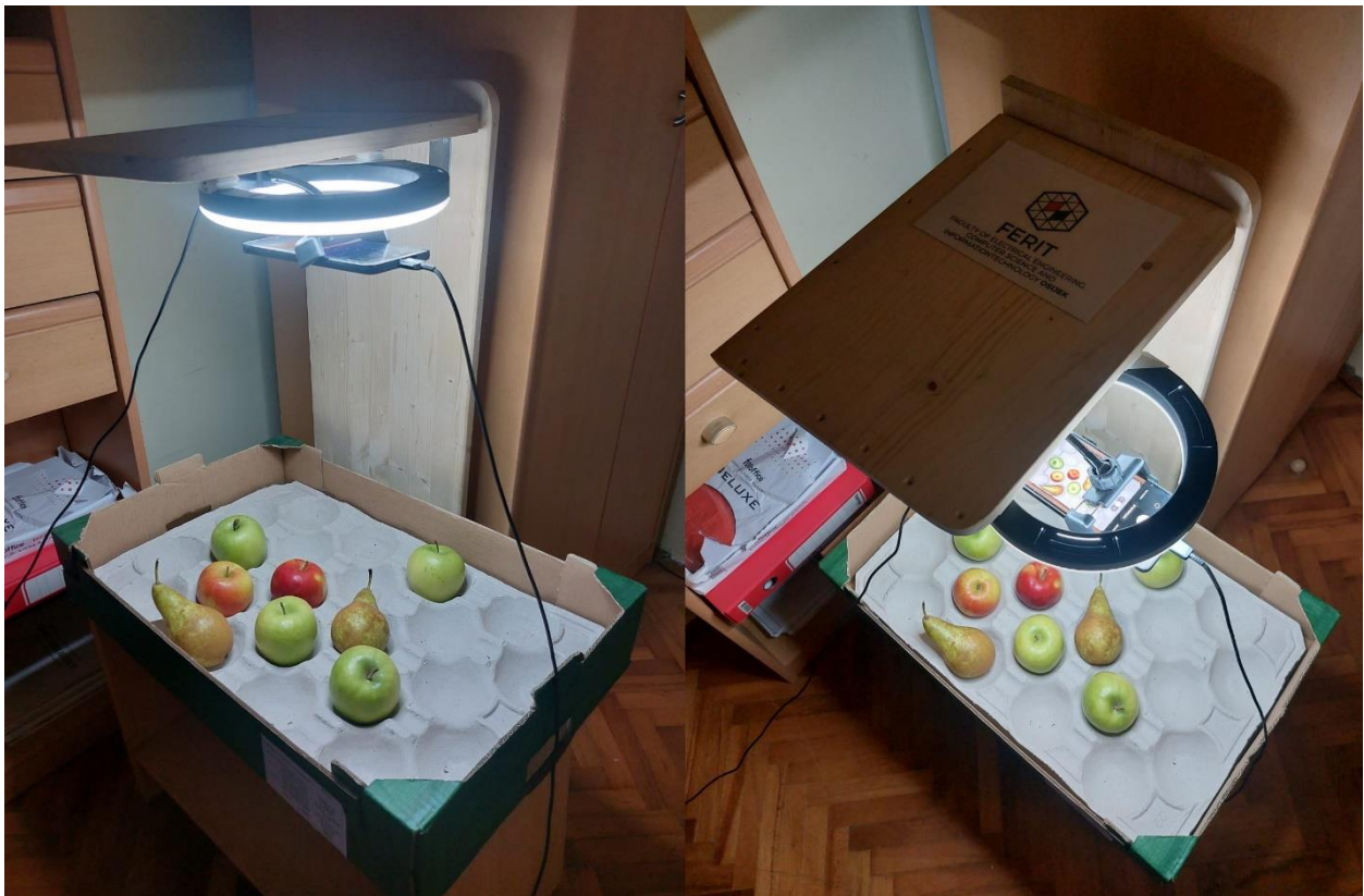
Slika 3.1. Prikaz izrađene makete za prikupljanje slika
