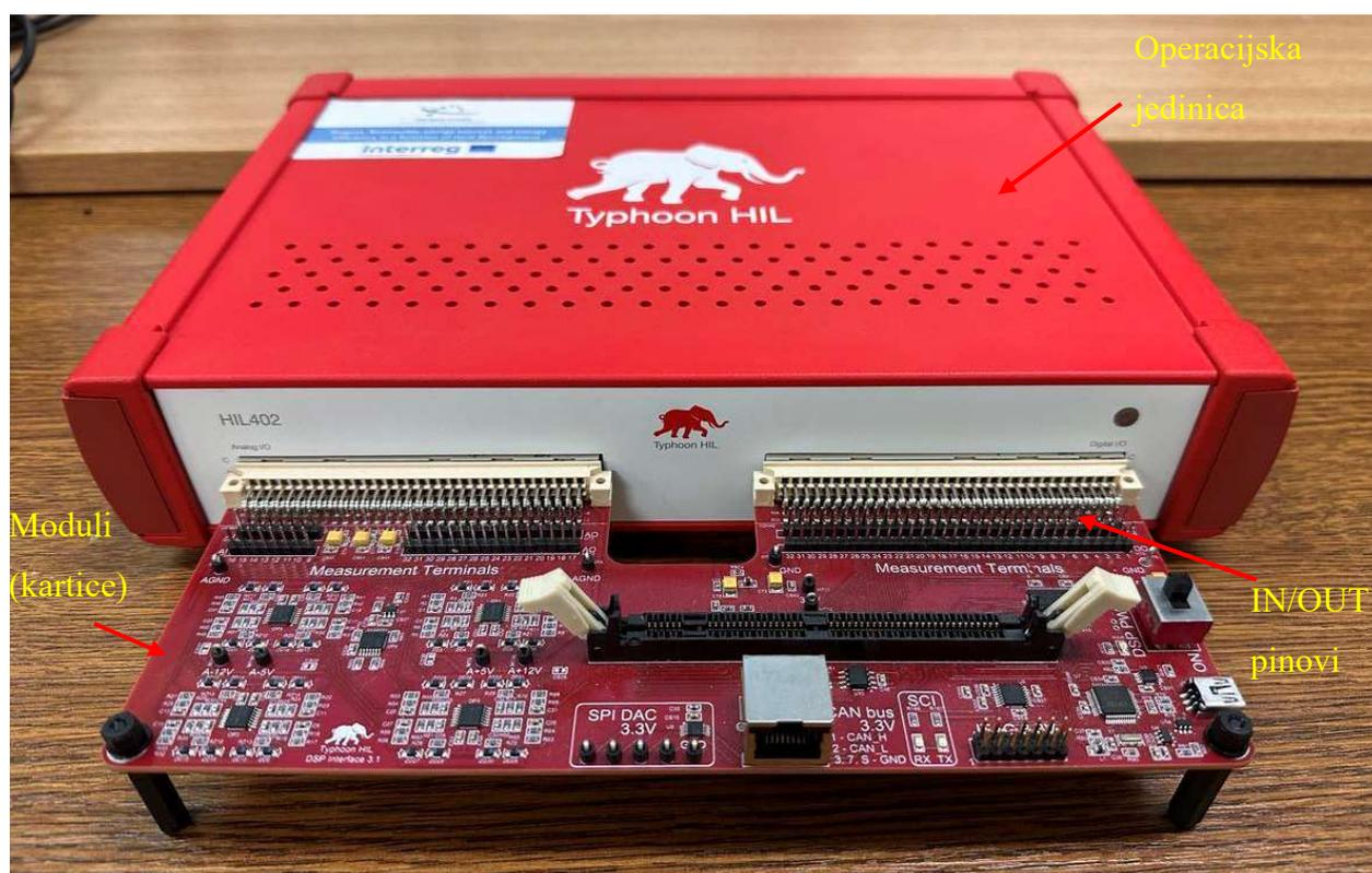
Slika 6.3 Hardverski dio Typhoon HIL-a
