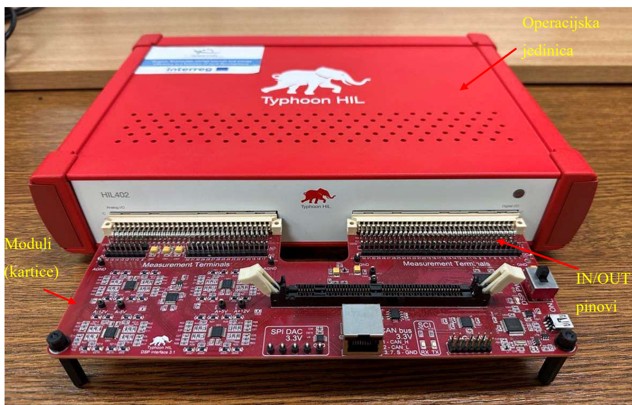
Slika 6.3 Hardverski dio Typhoon HIL-a
