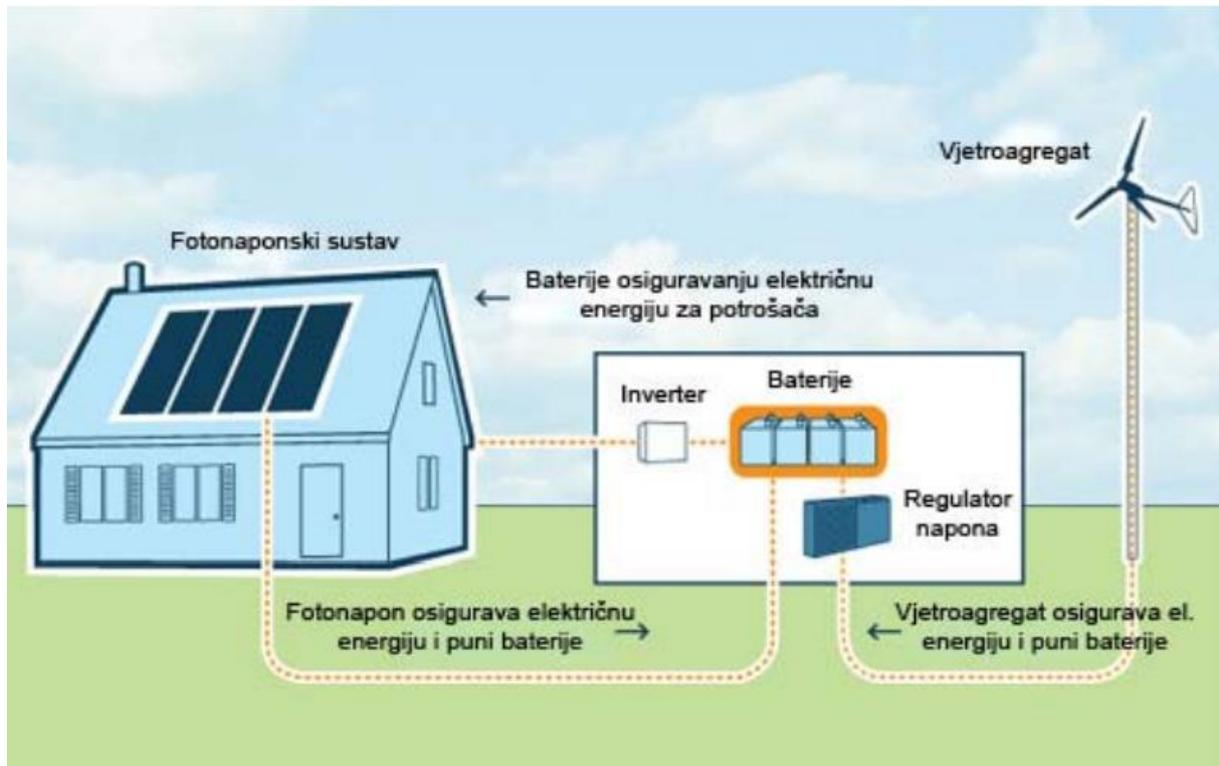
**Slika 5.12.** Shematski prikaz autonomnog hibridnog sustava [49]
