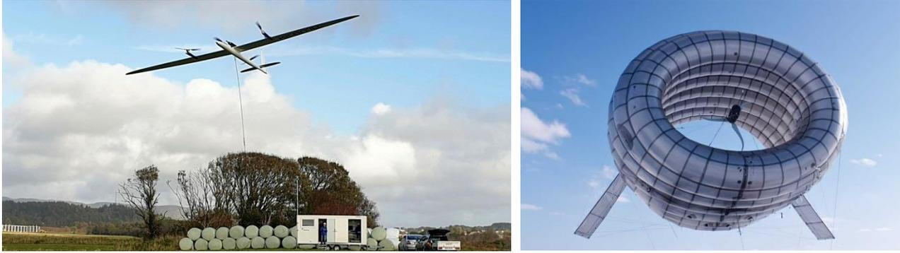
**Slika 4.5.** Aerodinamička (lijevo) i aerostatička izvedba (desno) zračnih vjetroagregata [23]
