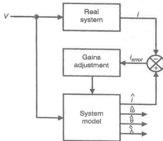
**Slika 4.6.** Blok dijagram sustava za procjenu položaja rotora [10].
