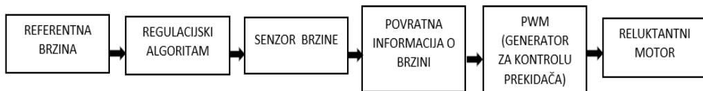
**Slika 3.1.** Blok shema za upravljanje sa senzorom brzine vrtnje
