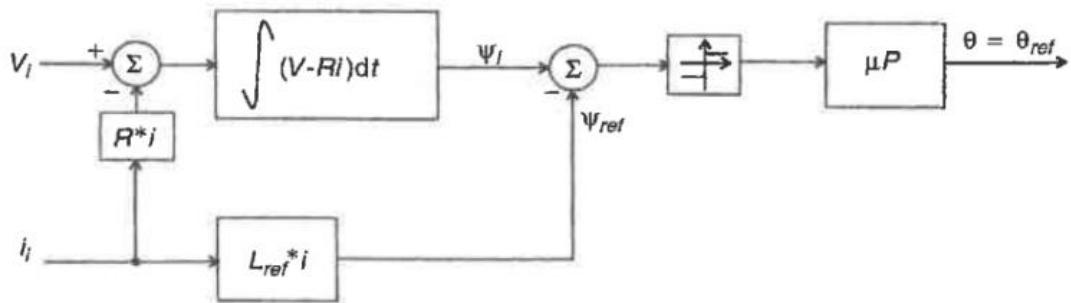
Slika 4.5. Blok dijagram za vezu magnetskog toka [10].
