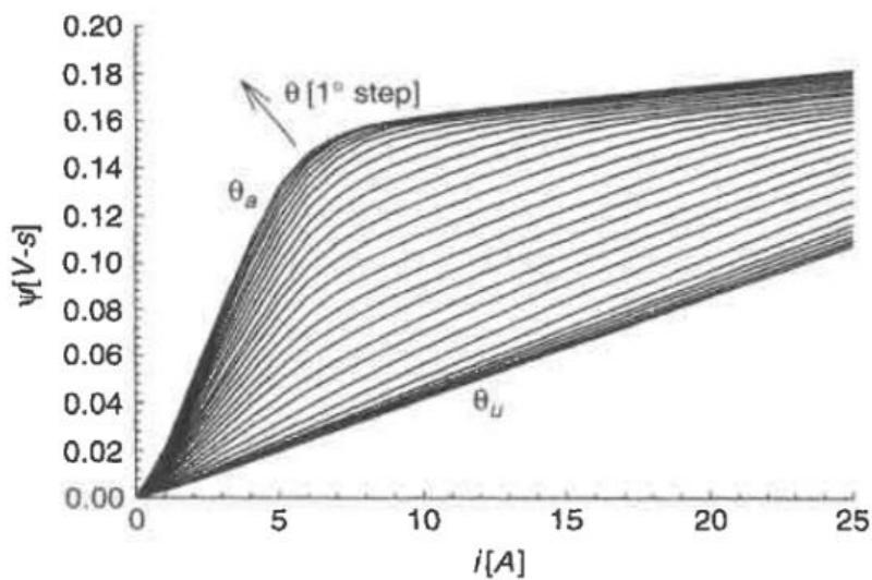
Slika 4.1. Izmjerene krivulje magnetizacije četverofaznog reluktantnog motora [10].
