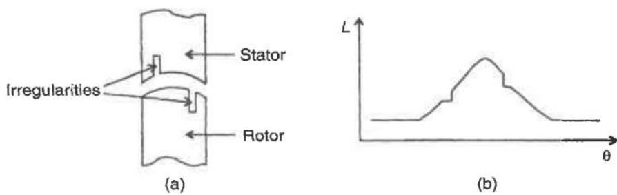
**Slika 4.8.** a) Nepravilnosti statora/rotora, b) Modificirani profil induktiviteta [10].
