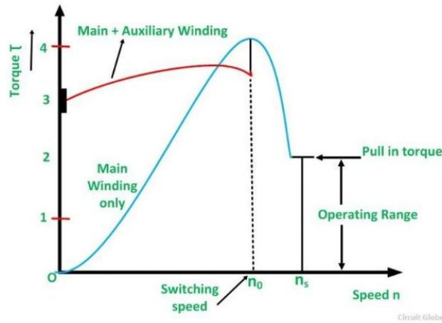
Slika 2.4. Karakteristika brzine momenta jednofaznog reluktantnog motora [7].
