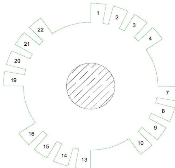
Slika 2.3. Rotor sa 4 istaknutu pola [5].
