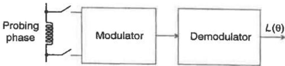
**Slika 4.11.** Blok dijagram tehnike modularnog signala [10].
