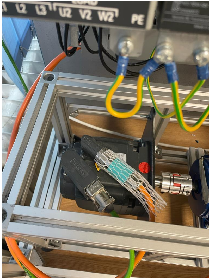
Sl. 5.7. Siemens simotics sinkroni motor sa permanentnim magnetima
