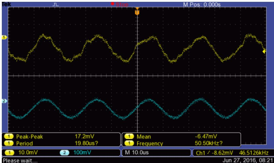
**Slika 5.8.** Sinusni oblik mjerena strujnim klijevima i Rogowskijevim svitkom pri struci od 86.2 mA i frekvenciji od 50 kHz [24]
