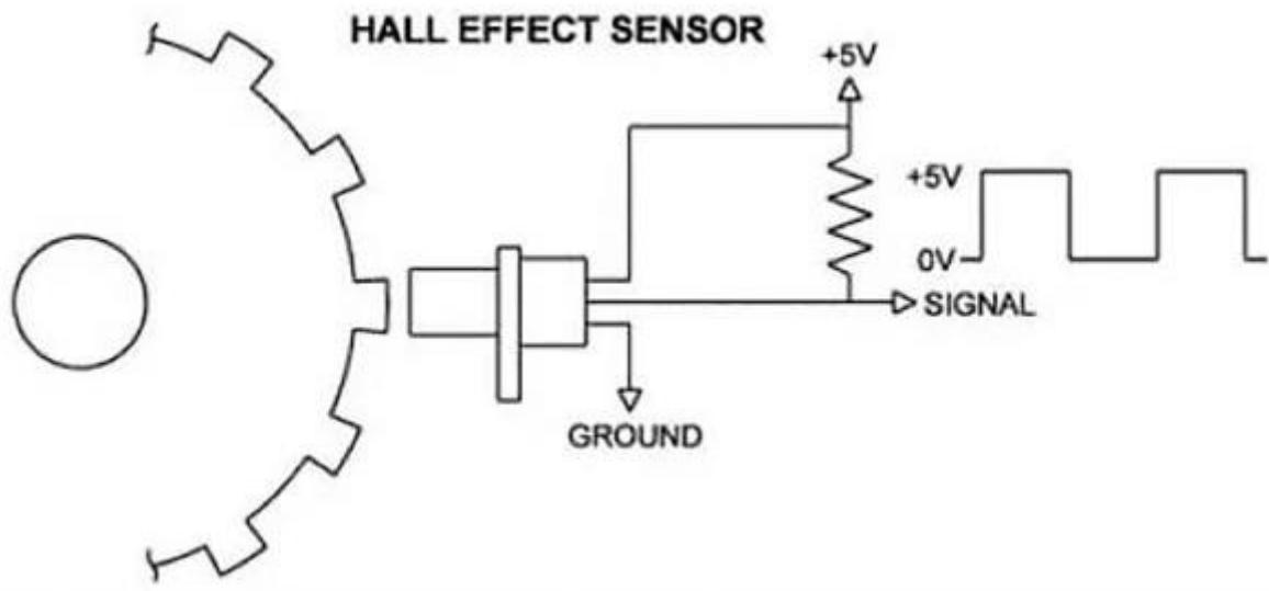
**Slika 3.10.** Shema spoja i izlazni napon Hallove sonde [11]
