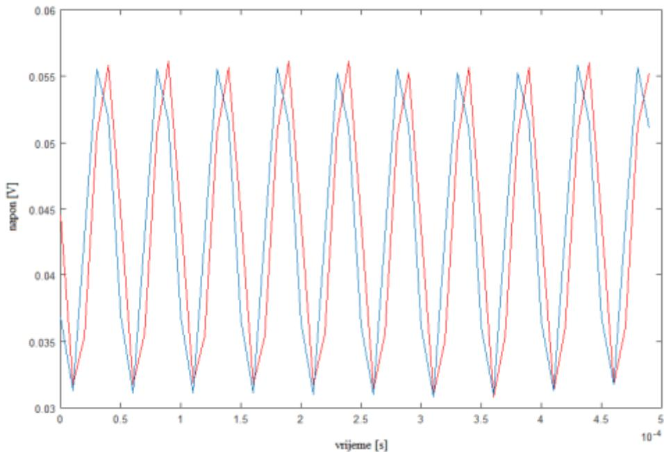
**Slika 5.7.** Signal sinusnog oblika izmjeren sa Rogowskijevim svitkom i strujnim kliještimi pri struji od 100 mA i frekvenciji od 20 kHz [24]
