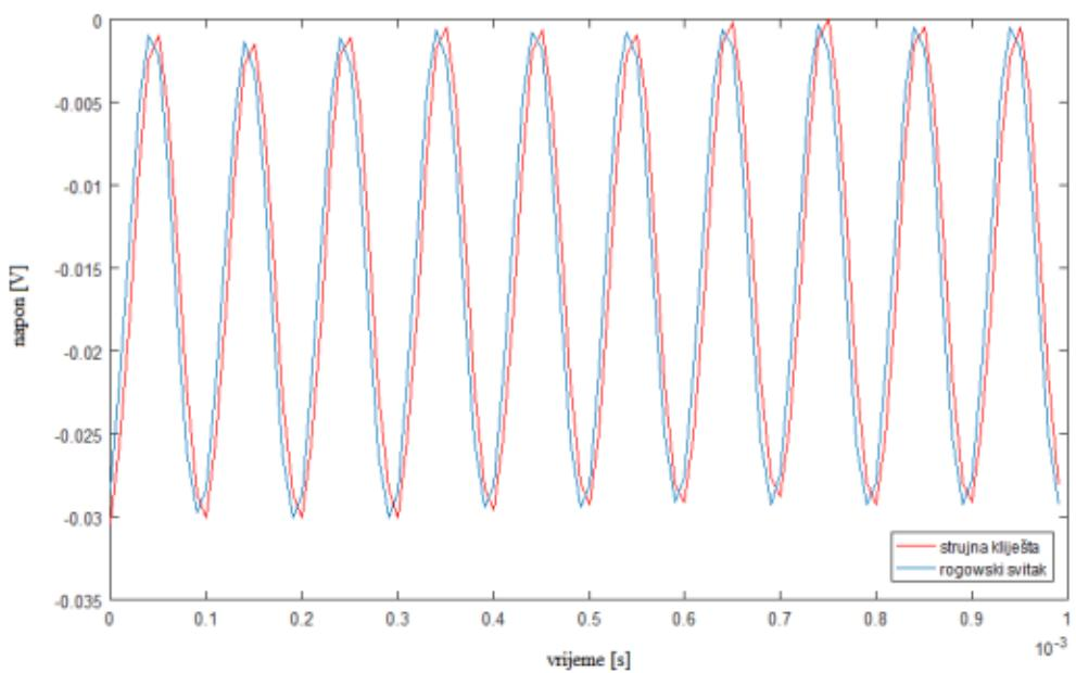
**Slika 5.6.** Signal sinusnog oblika izmjerен sa Rogowskijevim svitkom i strujnim kliještimi pri struji od 100 mA i frekvenciji od 10 kHz [24]
