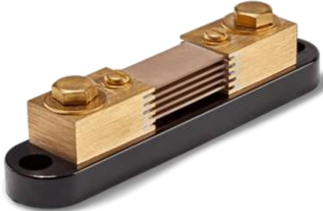
**Slika 3.2.** Shunt namijenjen za mjerjenje struja do 500 A, s izlaznim naponom od 50 ili  $100 \pm 0.1\%$  mV [4]
