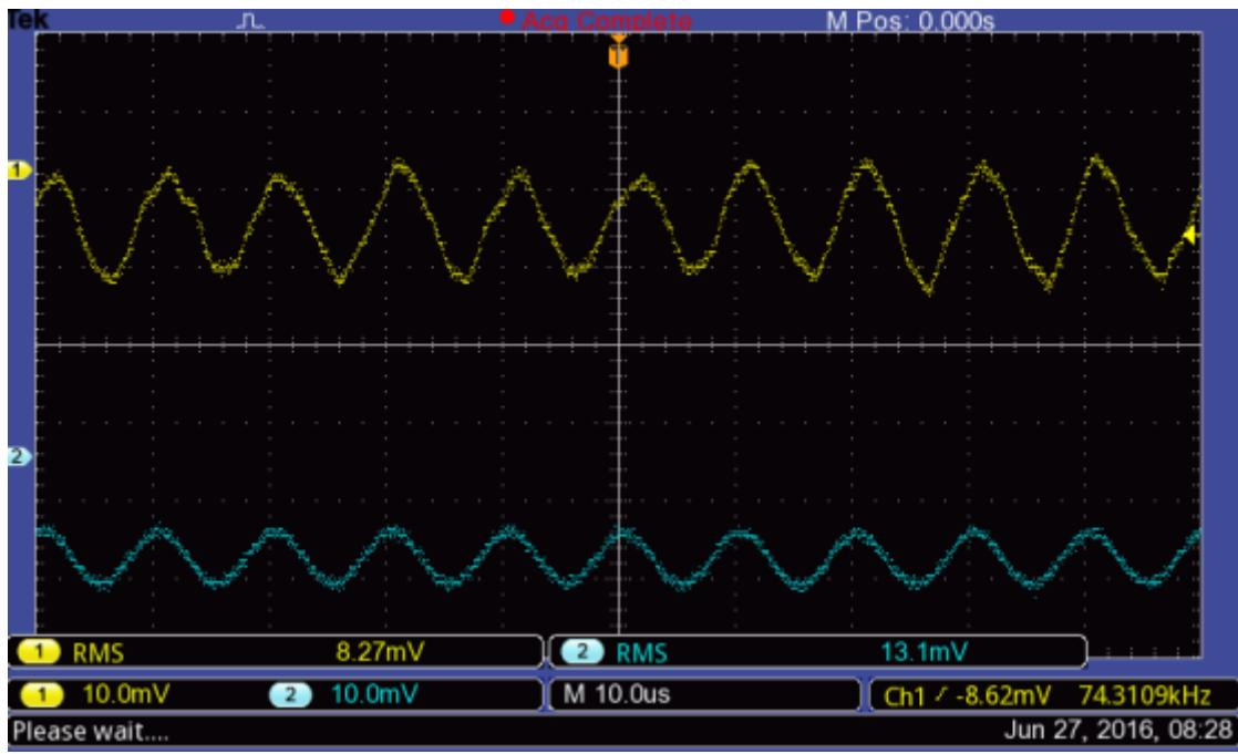
**Slika 5.9.** Sinusni oblik mjerjen strujnim kliještim i Rogowskijevim svitkom pri struji od 86.2 mA i frekvenciji od 75 kHz [24]
