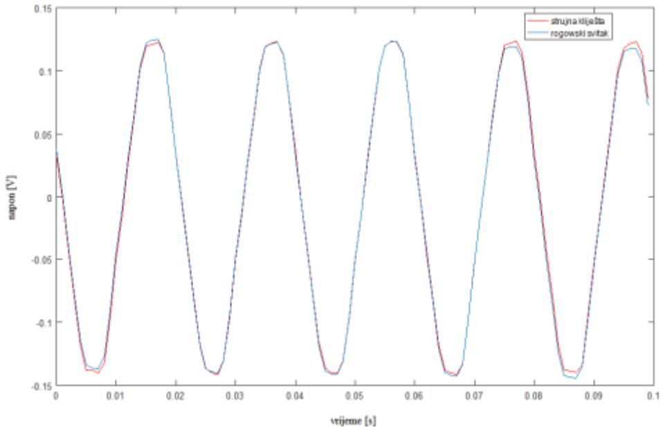
**Slika 5.4.** Signal sinusnog oblika izmjeren sa Rogowskijevim svitkom i strujnim kliještim u slučaju kada je mjerni vodič u središtu Rogowskijevog svitka. [24]
