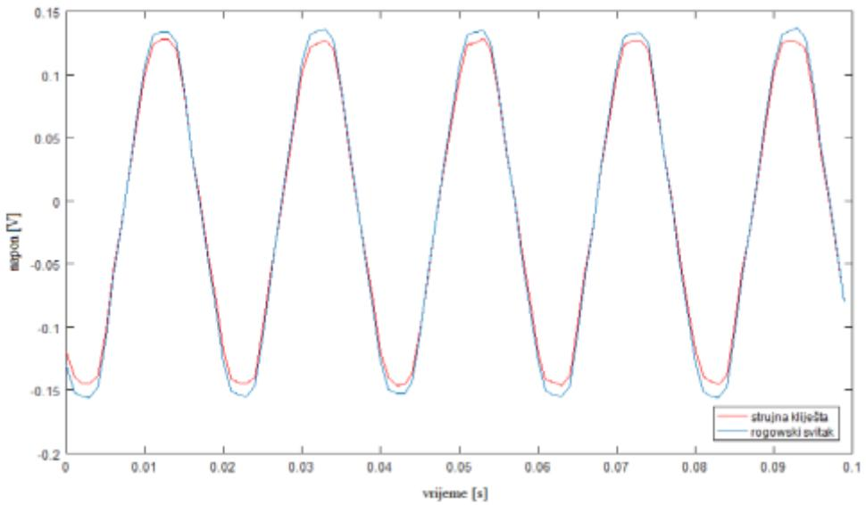
**Slika 5.3.** Signal sinusnog oblika izmjerен sa Rogowskijevim svitkom i strujnim kliještim u slučaju kada mjerni vodič dodiruje senzor Rogowskijevog svitka [24]
