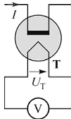
**Slika 3.13.** Strujni termopretvornik [1]
