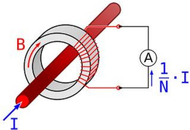
**Slika 3.5.** Princip rada strujnog transformatora [7]
