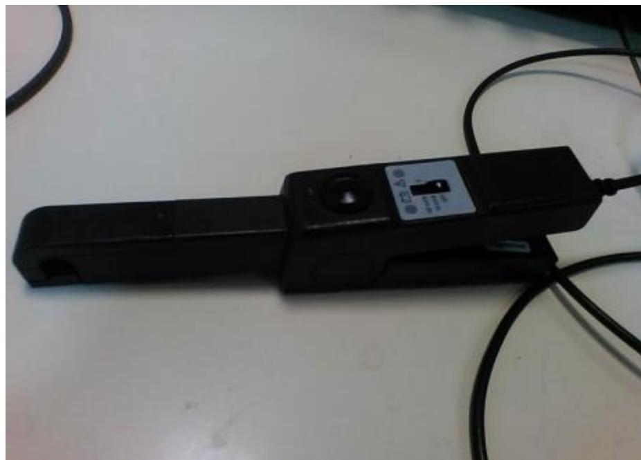
**Slika 5.1.** Strujna kliješta – Tektronix A622 AC/DC CURRENT PROBE [24]
