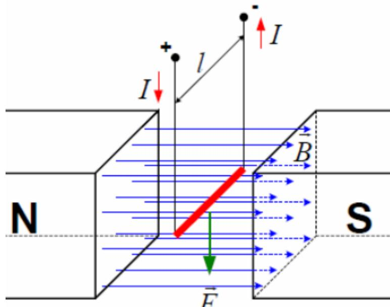
**Slika 3.7.** Smjer sile na vodič kojim protječe struja u magnetskom polju [9]
