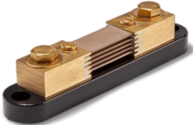
Slika 3.2. Shunt namijenjen za mjerenje struja do 500 A, s izlaznim naponom od 50 ili 100 \pm 0.1\% mV [4]
