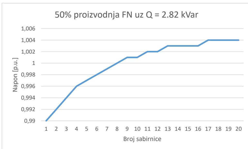
**Slika 4.93.** Napon na sabirnicama  $Q = 2.82$  kVar (50 % proizvodnja FN-a)
