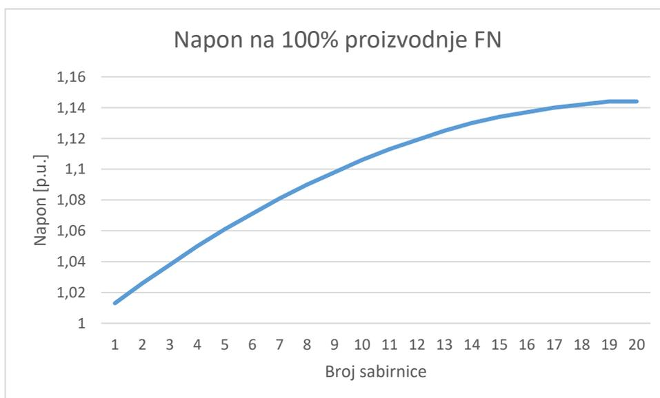
**Slika 4.5.** Napon na sabirnicama pri maksimalnoj proizvodnji FN-a
