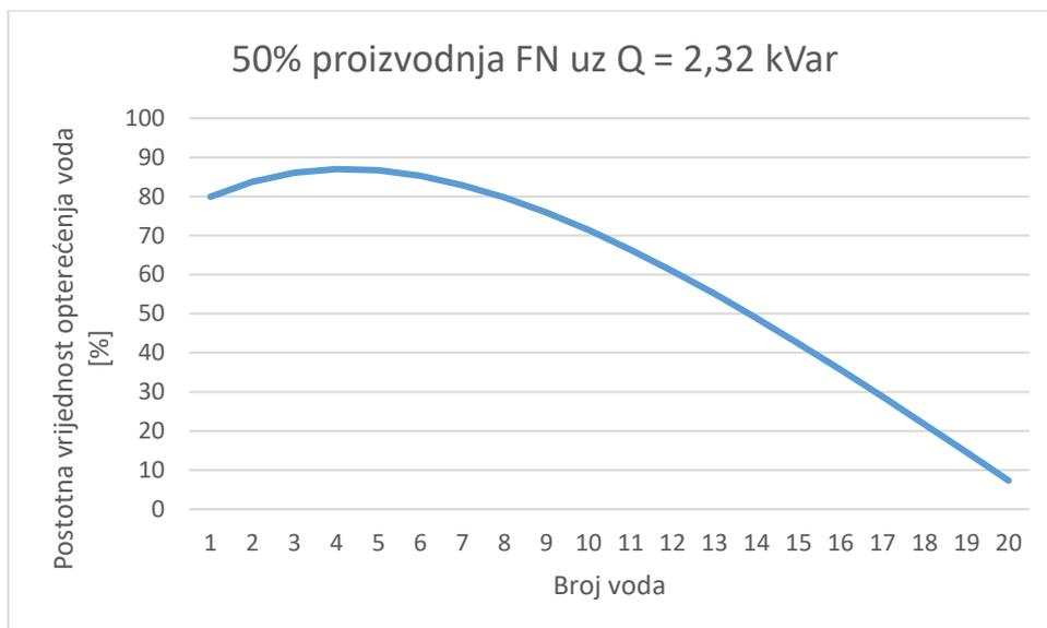
**Slika 4.97.** Opterećenje vodova pri  $Q = 2,32$  kVar (50 % proizvodnja FN-a)
