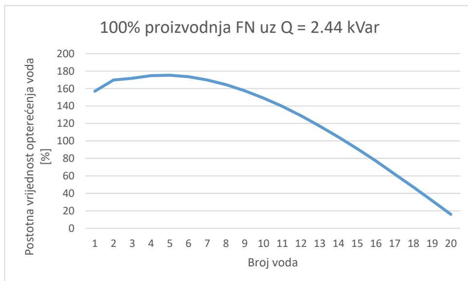
**Slika 4.79.** Opterećenje vodova pri  $Q = 2,44$  kVar (maksimalna proizvodnja FN-a)
