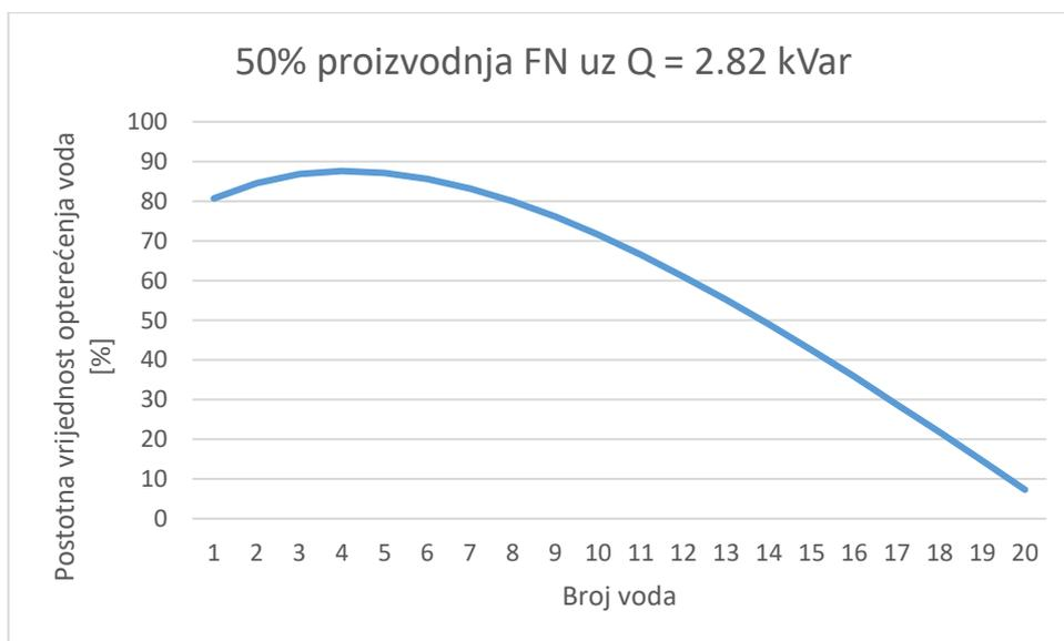
**Slika 4.98.** Opterećenje vodova pri  $Q = 2.82$  kVar (50 % proizvodnja FN-a)
