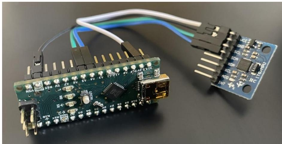
**Slika 3.3.** Spoj mikroupravljača Arduino Nano i MPU6050 senzora
