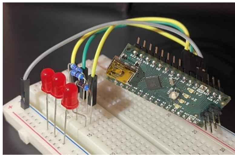
**Slika 3.4.** Spoj mikroupravljača Arduino Nano i svjetlećih dioda
