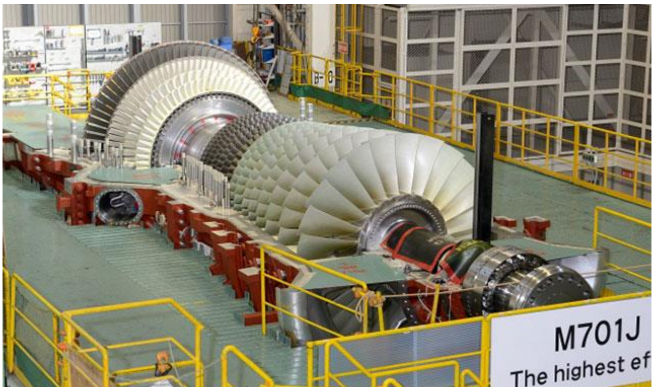
Slika 3.4. – Mitsubishi M701J turbina [12]
