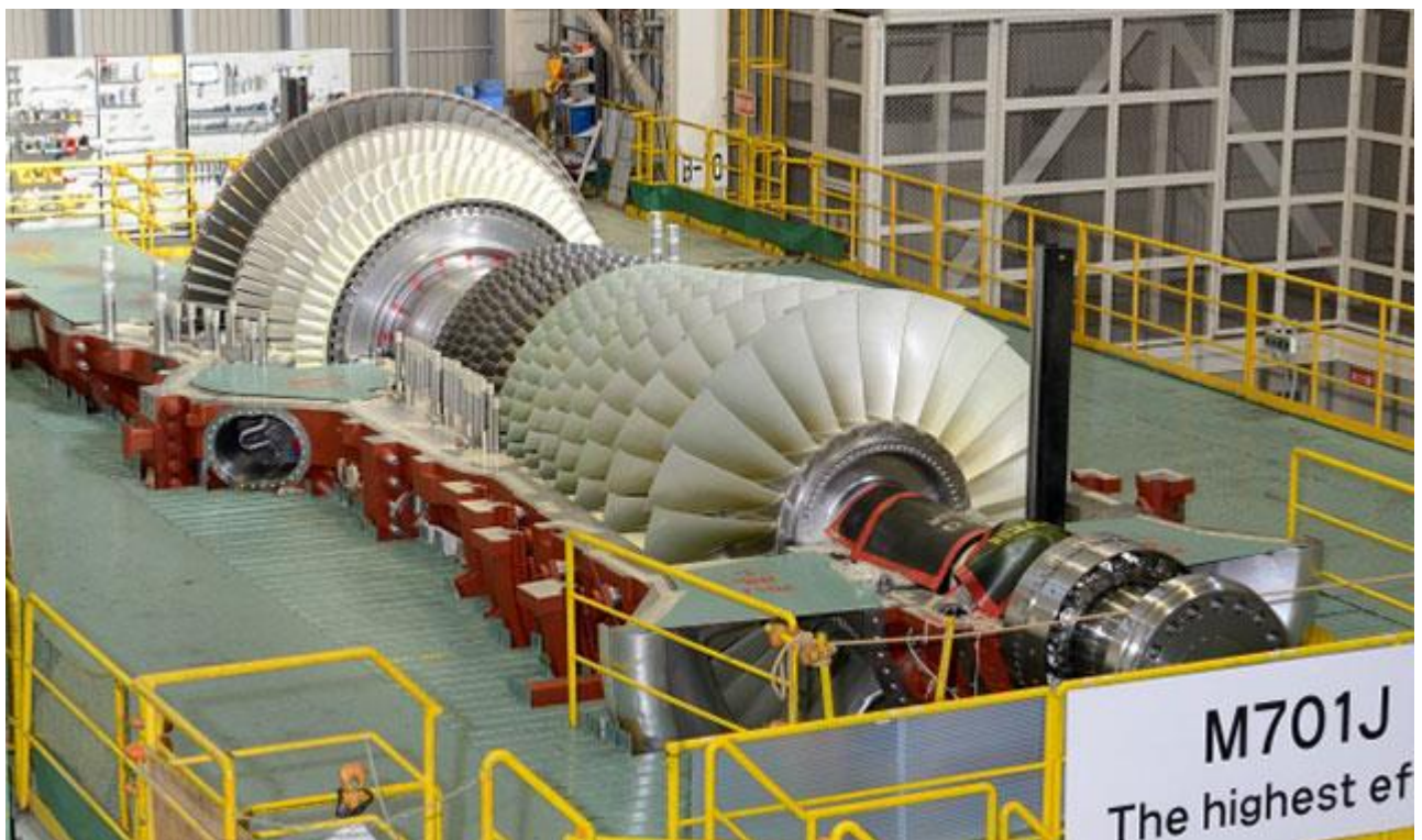
Slika 3.4. – Mitsubishi M701J turbina [12]
